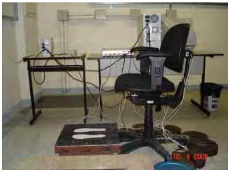
Figura 36 – Conjunto cadeira-plataforma de força e os instrumentos para medição: sistema computacional e SPIDER 8.
