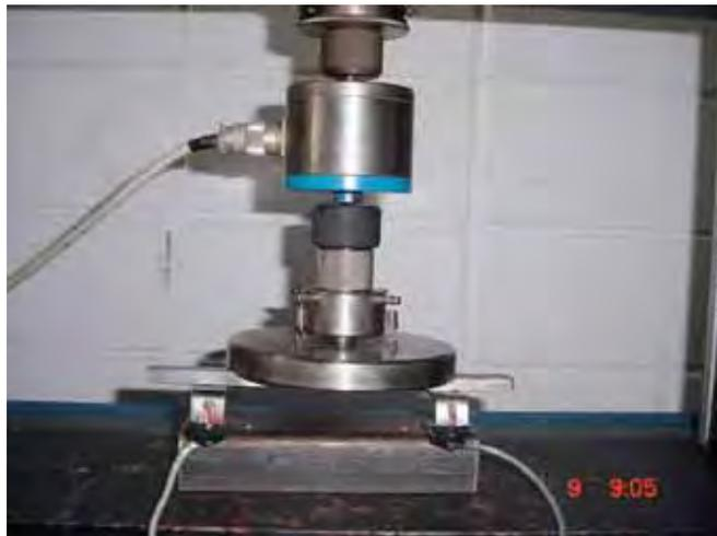
Figura 31 – Disco da EMIC aplicando carga compressiva sobre a barra metálica, posicionada em cima das células de carga, da parte da frente do assento.
