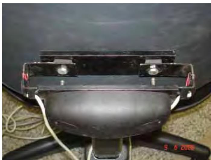
Figura 17 – Corpos deformáveis das células de carga do encosto, fixos na chapa metálica, presa ao suporte lombar da cadeira.
