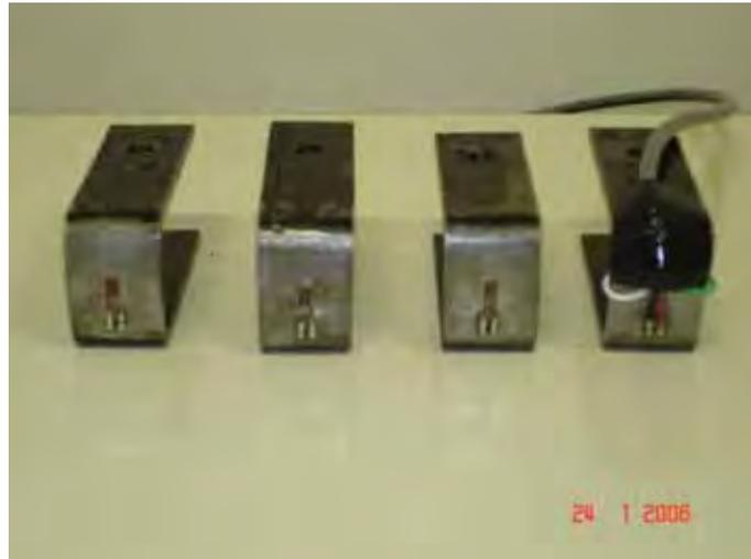
Figura 14 – Corpos das células de carga da parte anterior e posterior do assento. Destaque para os extensômetros colados na superfície vertical externa desse material.
