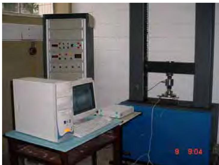
Figura 24 – Sistema computacional, SPIDER 8 e EMIC-painel de controle e disco de compressão, no Laboratório de Ensaio Mecânicos, do DMT.
