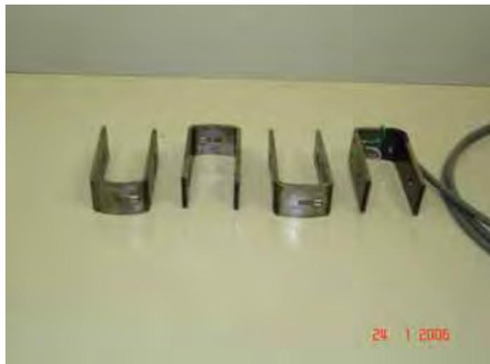
Figura 15 – Corpos das células de carga da parte anterior e posterior do assento. Destaque para os extensômetros colados na superfície interna de cada corpo deformável.
