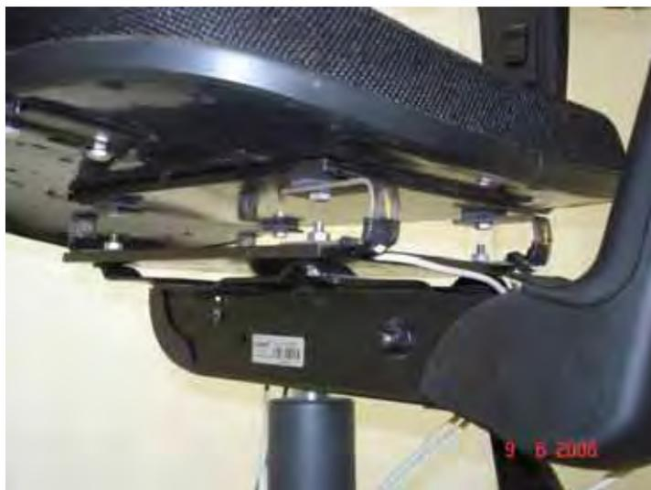
Figura 16 – Corpos deformáveis das células de carga da parte anterior e posterior do assento fixos na chapa metálica, presa à base da cadeira.
