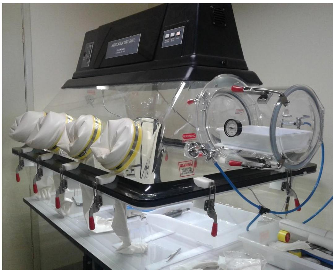
*Figura 7: Glove Box utilizada na preparação dos filmes finos*
