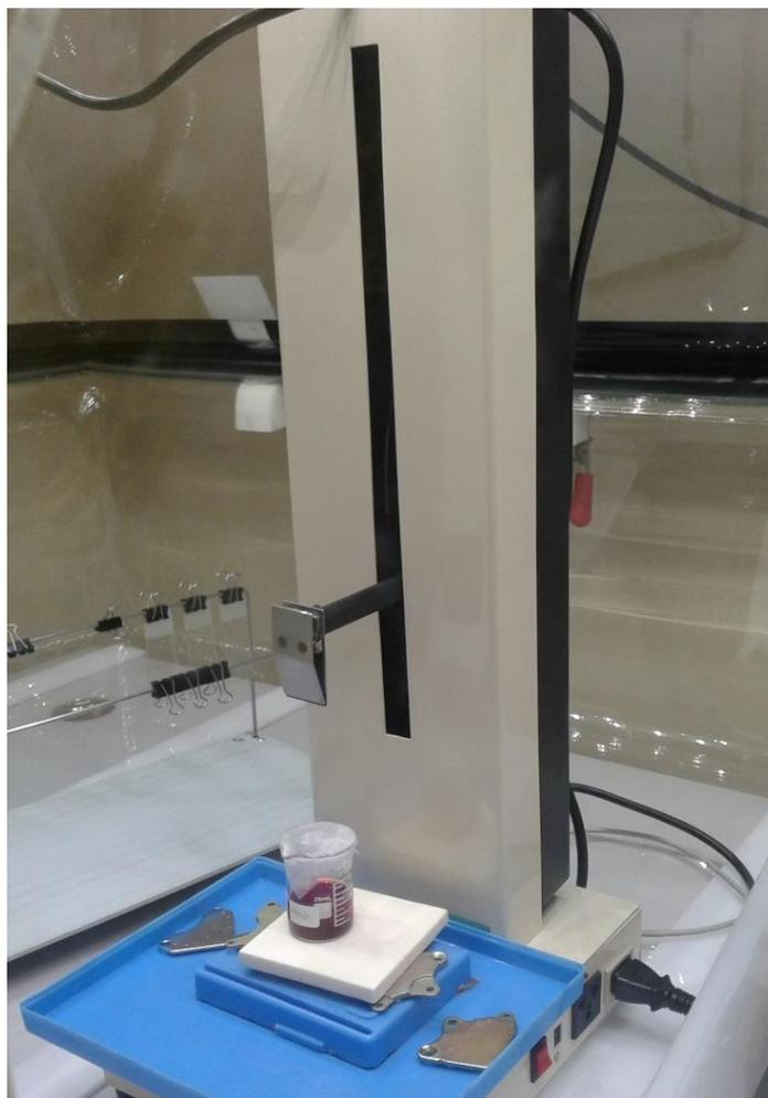
*Figura 8: Detalhe de dentro da Glove Box com o Dip-Coater*
