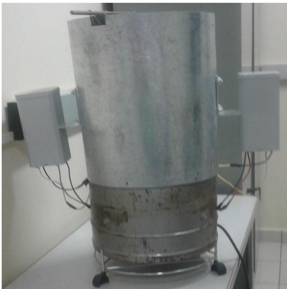
*Figura 10: Equipamento construído para a realização de tratamento com Luz UV*
