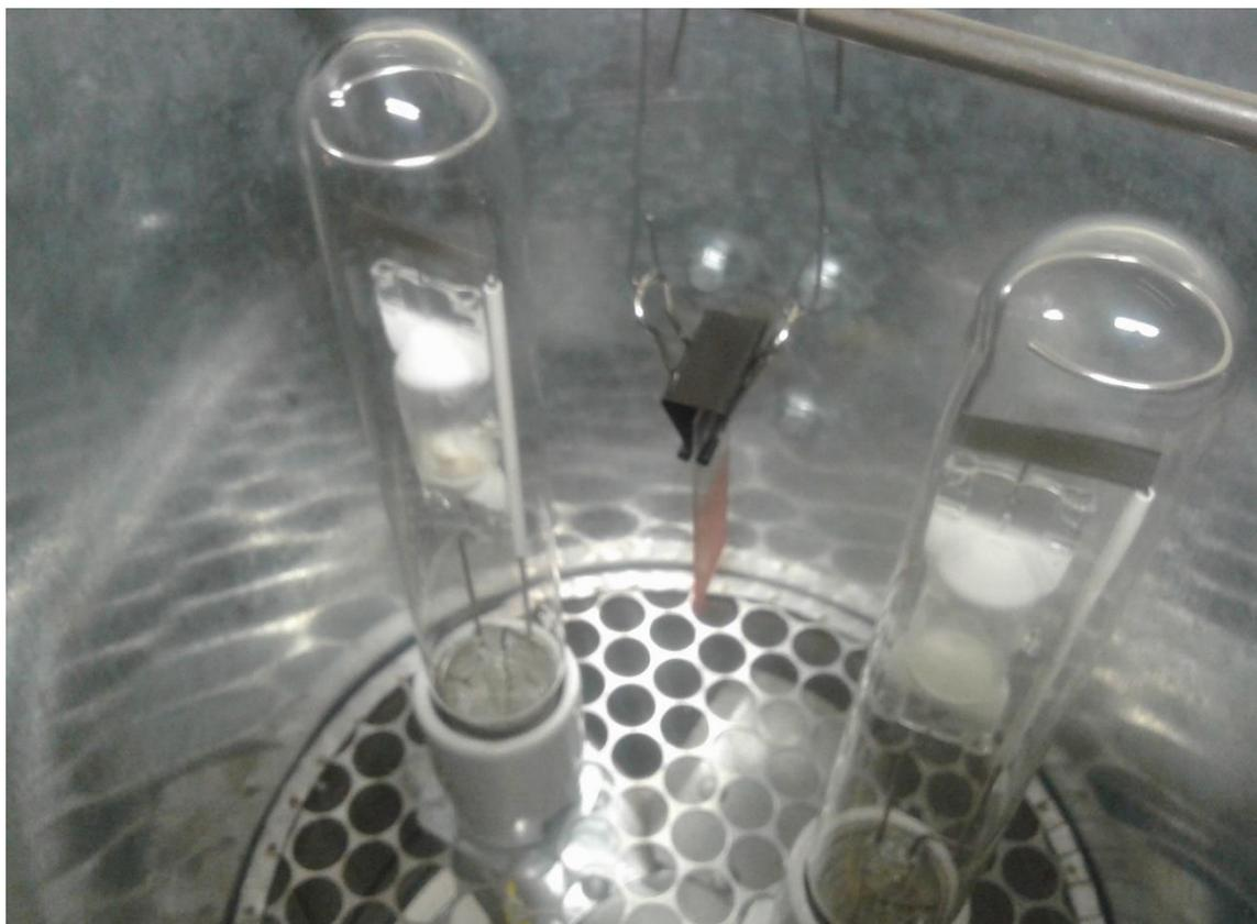
*Figura 11: Detalhe da posição da amostra (paralela as lâmpadas UV)*
