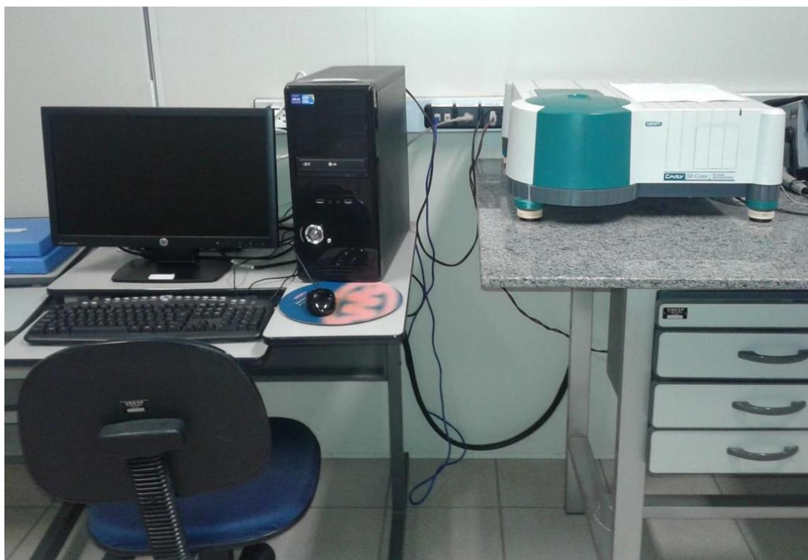
*Figura 13: Espectrofotômetro "Varian Cary-50" utilizado nas medidas de absorção UV-Vis*
