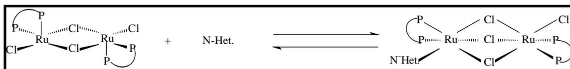
Figura 3.2 - Rota para obtenção de complexos binucleares de  $\text{Ru}_2(\text{II,II})$
