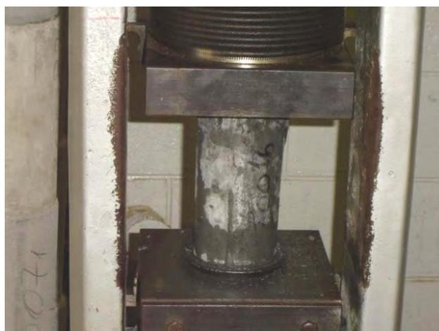
**Figura 40.** Corpo-de-prova do traço com 5% CCA-C submetido a resistência à compressão.
