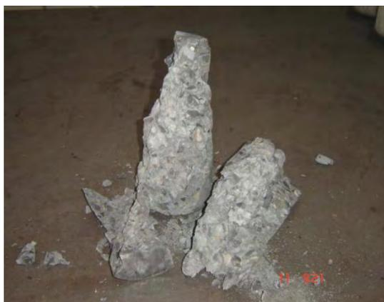
**Figura 55.** Corpo-de-prova submetido ao ensaio de resistência à compressão do traço 5% CCA-C.
