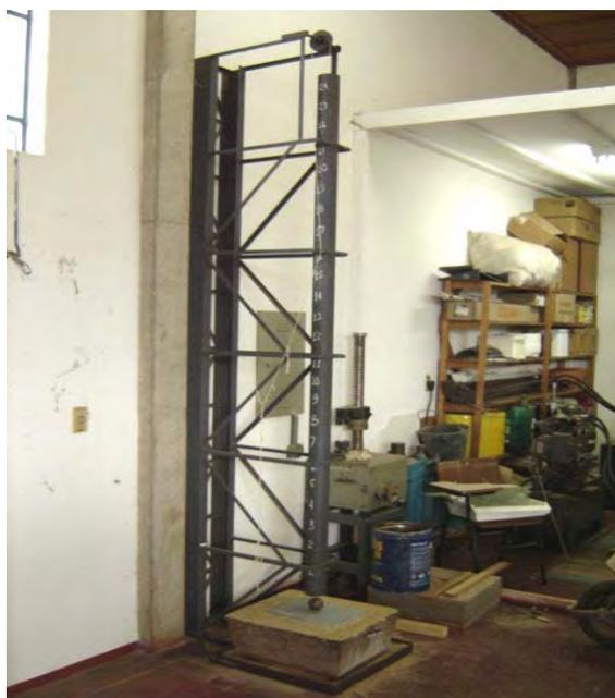
**Figura 43.** Equipamento para o ensaio de resistência ao impacto.
