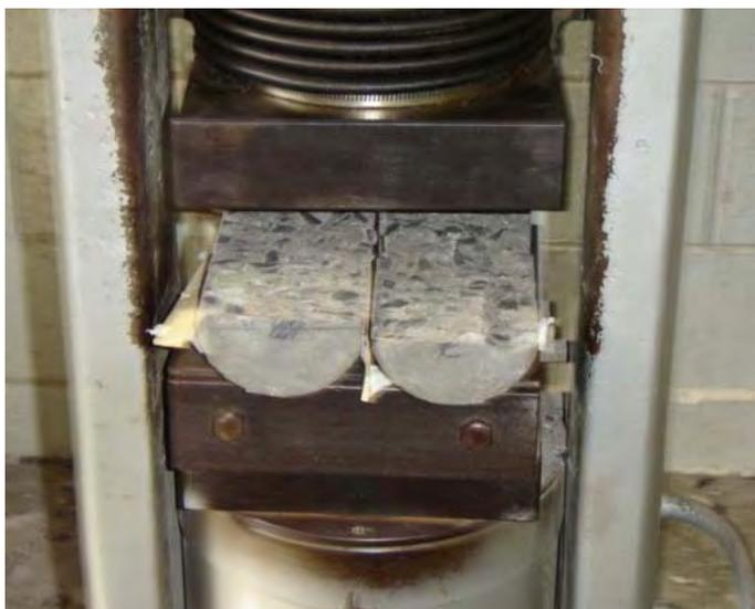
**Figura 41.** Corpo-de-prova do traço com 5% CCA-A submetido a resistência à tração.
