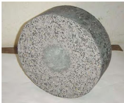
**Figura 88.** Desgaste à abrasão – CCA-C/Bor.
