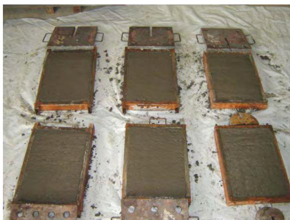
**Figura 37.** Moldagem dos corpos-de-prova (5 x 15 x 30 cm).
