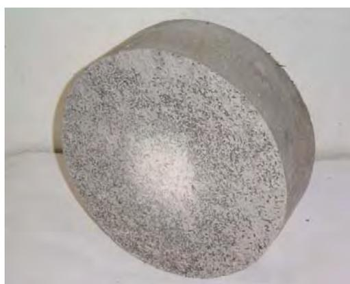
**Figura 90.** Desgaste à abrasão - CCA-A/Bor..
