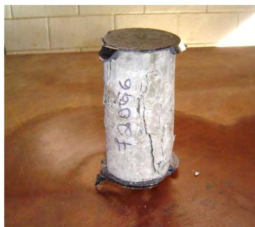
**Figura 61.** Corpo-de-prova rompido a resistência à compressão – Controle/Bor..
