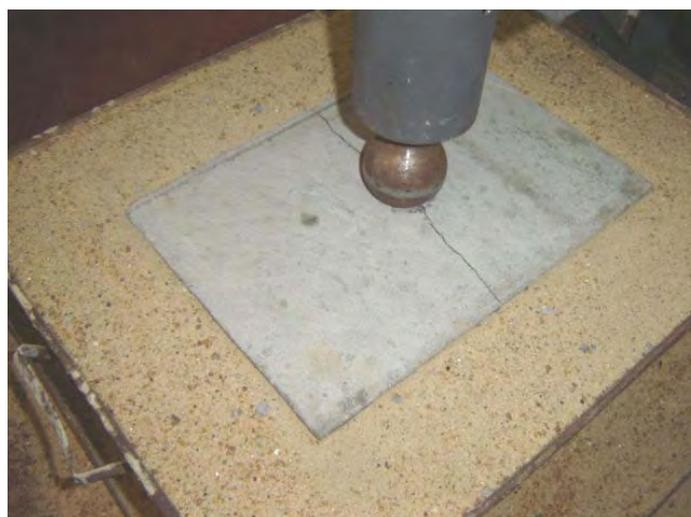
**Figura 45.** Corpo-de-prova ensaiado – 5% CCA-A.
