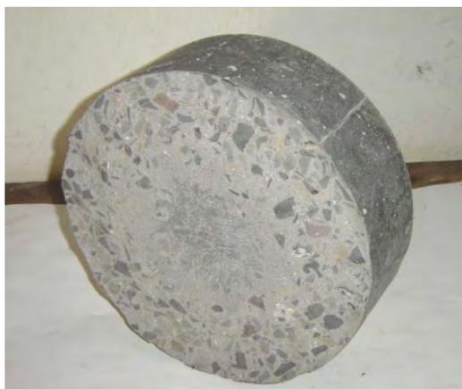
**Figura 87.** Desgaste à abrasão – 5% CCA-C
