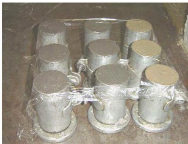
**Figura 28.** Corpos-de-prova após a moldagem.
