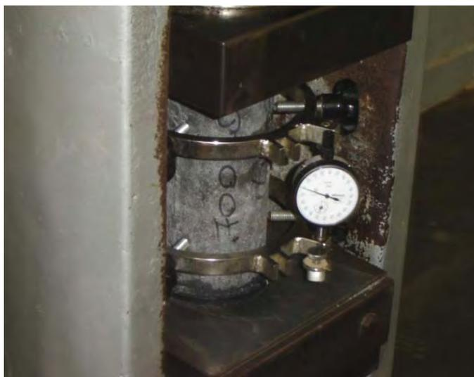
**Figura 42.** Detalhe do corpo-de-prova ajustado para a realização do ensaio do módulo de elasticidade.
