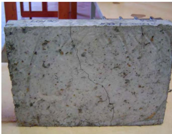
Figura 83. Corpo-de-prova do traço Sílica/Bor. após o término do ensaio.
