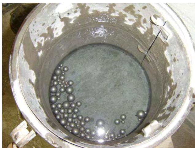
**Figura 49.** Corpo-de-prova submerso no recipiente do ensaio de resistência à abrasão.
