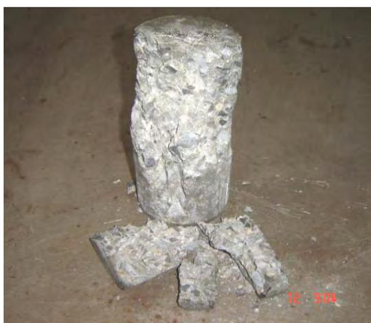
**Figura 60.** Corpo-de-prova rompido a resistência à compressão - Controle.
