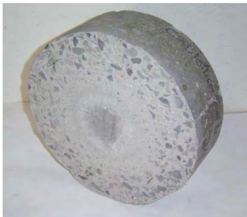
**Figura 91.** Desgaste à abrasão – 5% Sílica.
