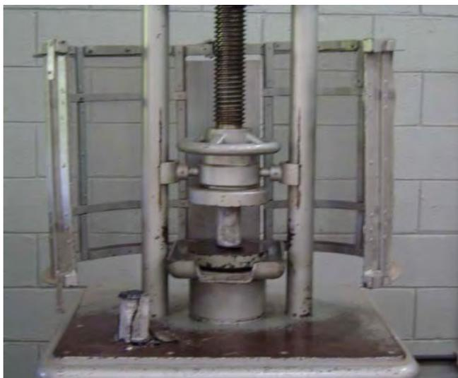
**Figura 29.** Corpos-de-prova submetidos à ruptura (resistência à compressão).
