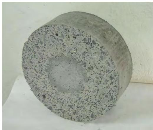
**Figura 92.** Desgaste à abrasão – Sílica/Bor.
