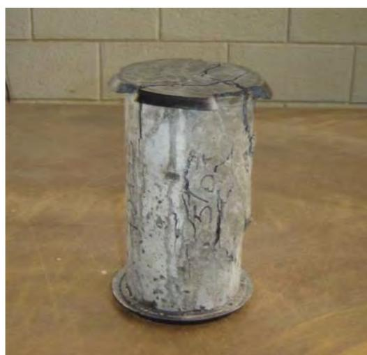
**Figura 67.** Corpo-de-prova rompido a resistência à compressão – Sílica/Bor..
