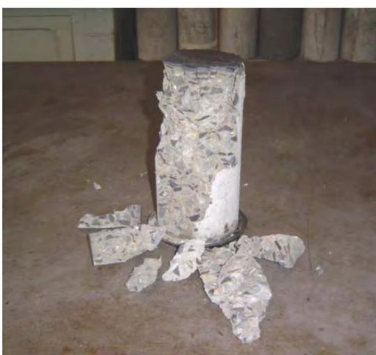
**Figura 66.** Corpo-de-prova rompido a resistência à compressão – 5% Sílica.
