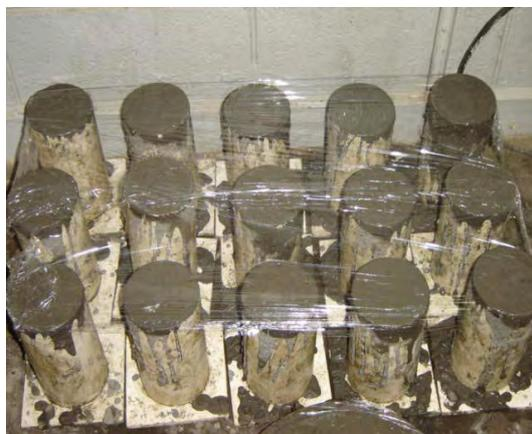
**Figura 35.** Após moldagem dos corpos-de-prova (10 x 20 cm).
