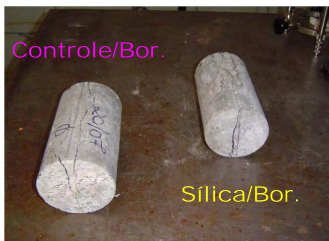
**Figura 71.** Corpo-de-prova rompido a resistência à tração.
