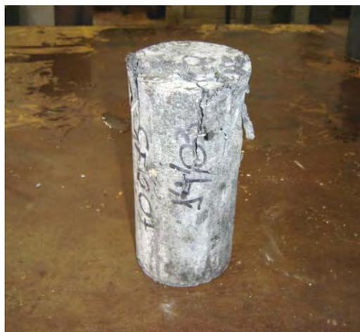
**Figura 63.** Corpo-de-prova rompido a resistência à compressão - CCA-C/Bor..
