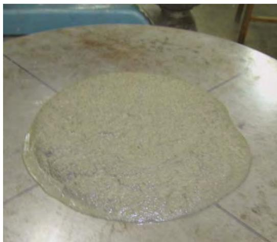
**Figura 27.** Determinação do índice de consistência.
