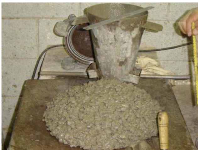
**Figura 32.** Ensaio de abatimento de cone tronco.
