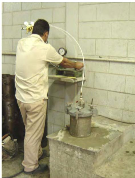
**Figura 33.** Aparelho medidor de ar.
