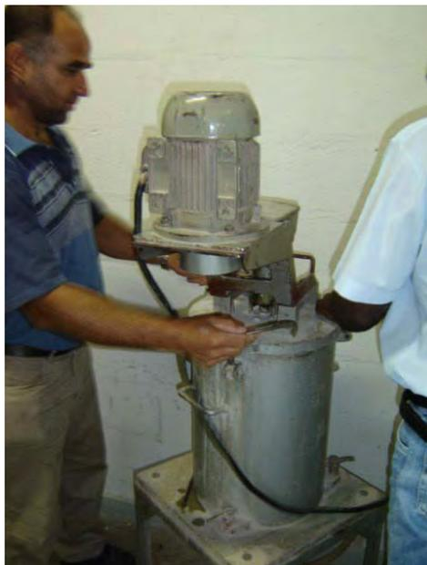
**Figura 48.** Aparelho para o ensaio de resistência à abrasão.
