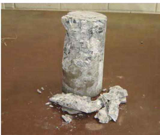
**Figura 64.** Corpo-de-prova rompido a resistência à compressão – 5% CCA-A.
