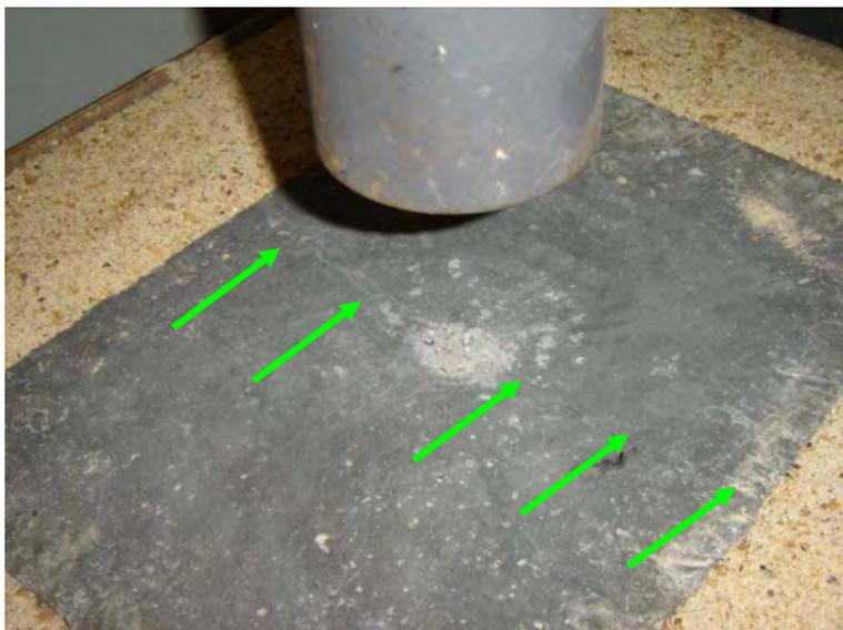
**Figura 78.** 1ª fissura (0,05 mm) - CCA-C/Bor. submetido a resistência ao impacto.
