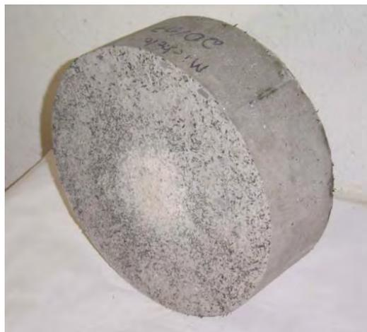
**Figura 86.** Resistência à abrasão – Controle/Bor.
