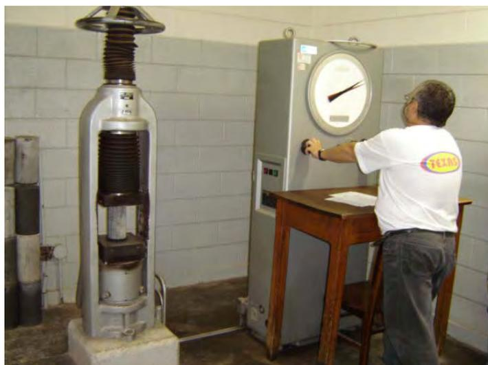
**Figura 39.** Prensa hidráulica para realização dos ensaios.
