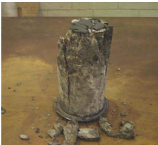
**Figura 62.** Corpo-de-prova rompido a resistência à compressão –5% CCA-C.
