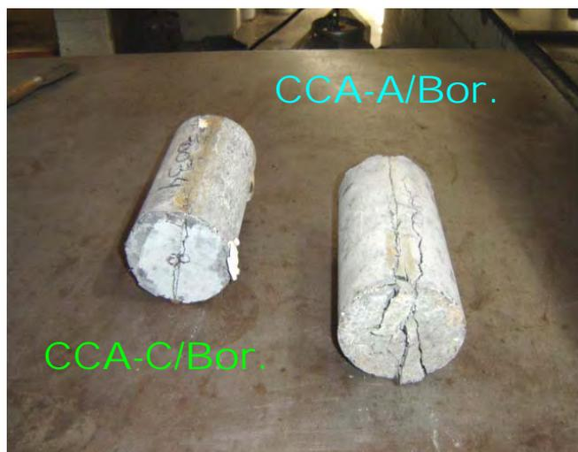
**Figura 70.** Corpo-de-prova rompido a resistência à tração.
