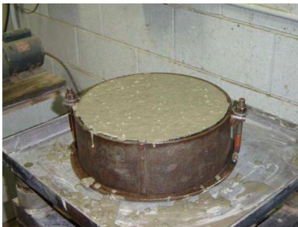
**Figura 36.** Moldagem do corpo-de-prova (30 x 10 cm).
