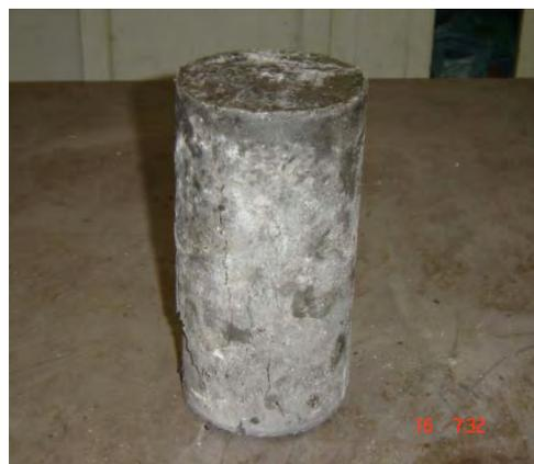
**Figura 56.** Corpo-de-prova submetido ao ensaio de resistência à compressão do traço CCA-C/Bor..
