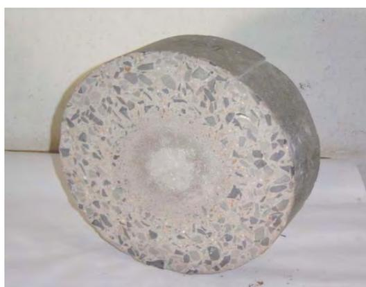
**Figura 89.** Desgaste à abrasão – 5% CCA-A.
