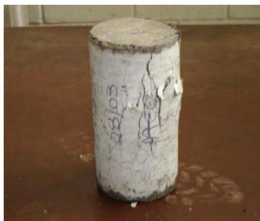
**Figura 65.** Corpo-de-prova rompido a resistência à compressão – CCA-A/Bor..
