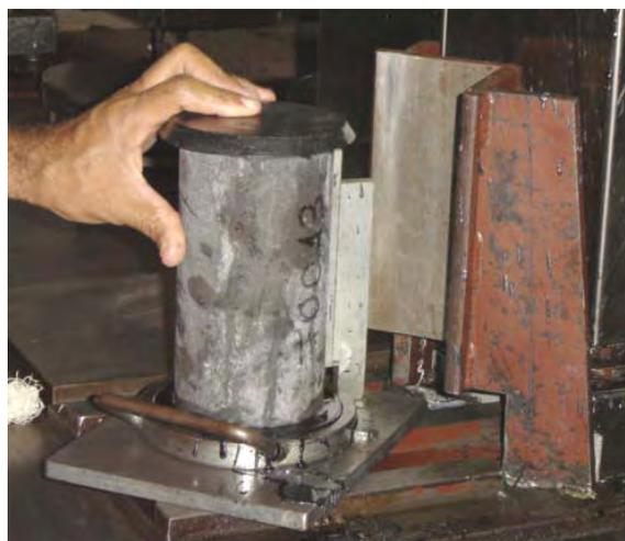
**Figura 38.** Corpos-de-prova submetidos ao capeamento.
