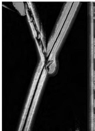
**Figura 6-24:** Mapa de elevação resultante da aplicação da rotina de reconstrução a partir do paralaxe aplicada no nanofio mostrado na Figura 6-21.
