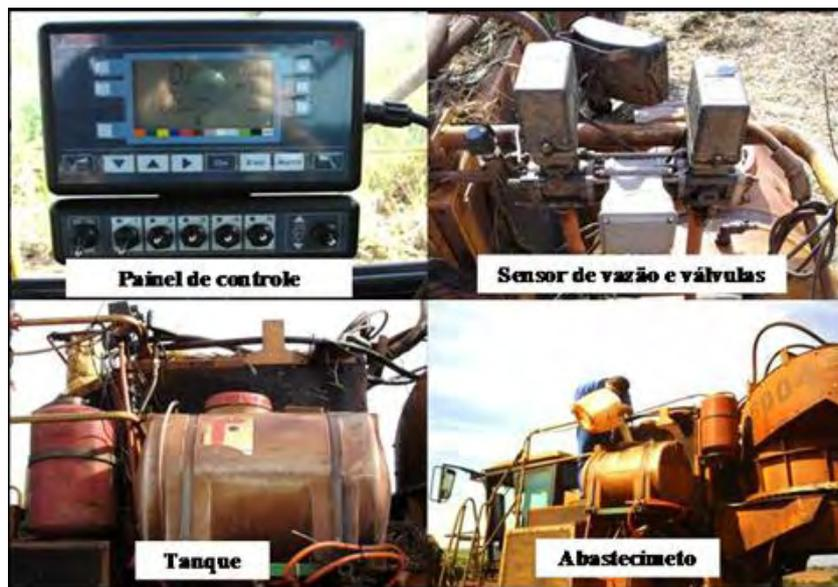
**Figura 8.** Detalhes do sistema de pulverização, instalado na colhedora de cana-de-açúcar.
