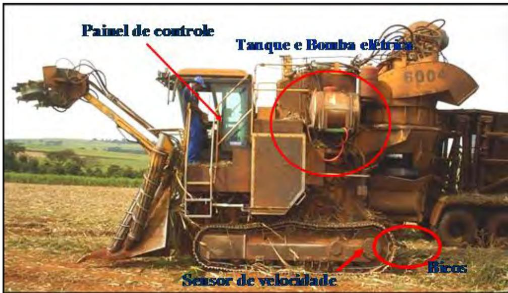
**Figura 7.** Sistema de pulverização instalado na colhedora de cana-de-açúcar.
