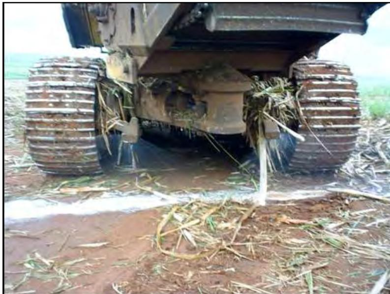
**Figura 9.** Detalhe dos bicos de pulverização, instalados na colhedora de cana-de-açúcar
