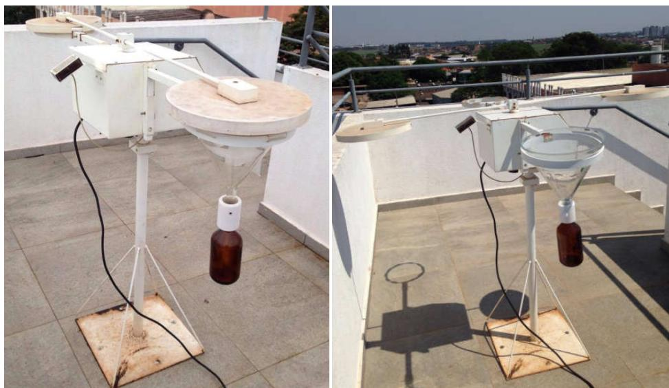
**Figura 4.** Sistema de coleta de amostras de água de chuva com coletor automático. (A) sistema fechado. (B) coletor com tampa aberta para coleta da amostra.
