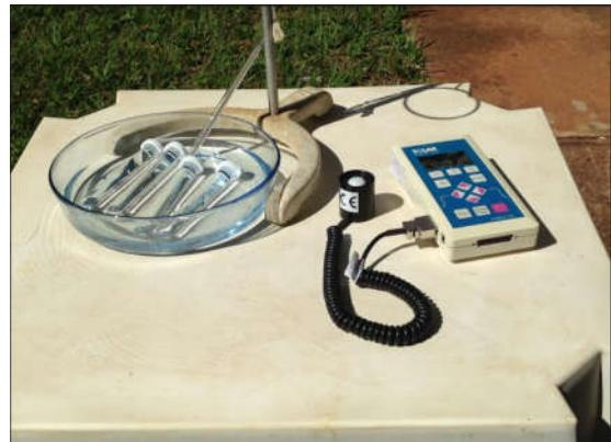
**Figura 5.** Montagem do experimento de fotoquímica mostrando o radiômetro, sensor e tubos de quartzo parcialmente imersos em água.
