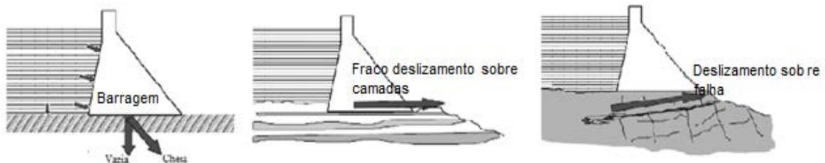
**Figura 10:** Planos potenciais para deslizamento das fundações das barragens sob pressão do reservatório (Mod. PRICE, 2009).
