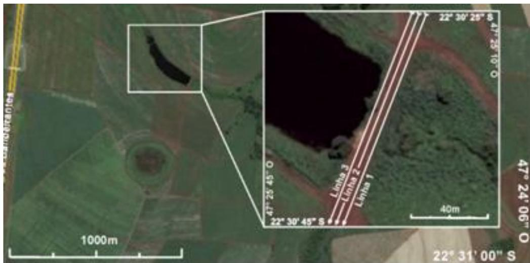
**Figura 20:** Área da barragem com a disposição das três linhas de aquisição
