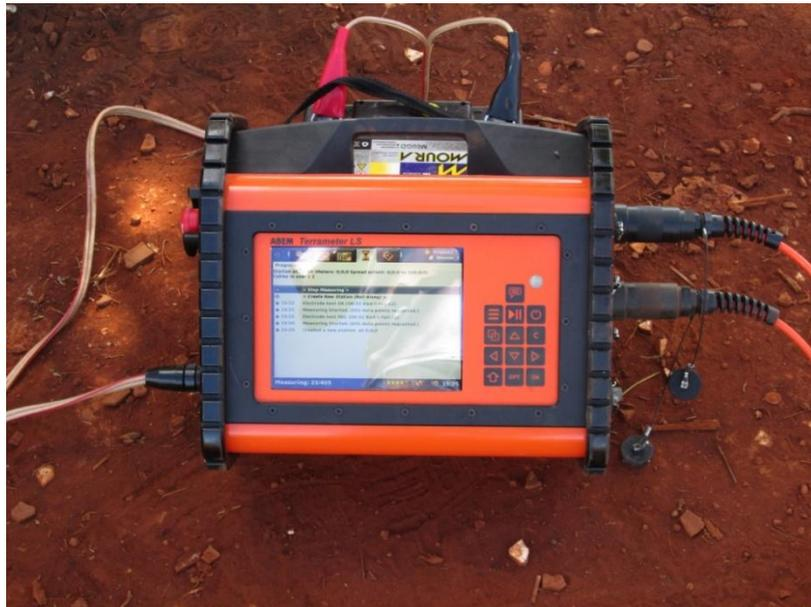
**Foto 5:** Aparelho geofísico Terrameter LS durante a aquisição dos dados
