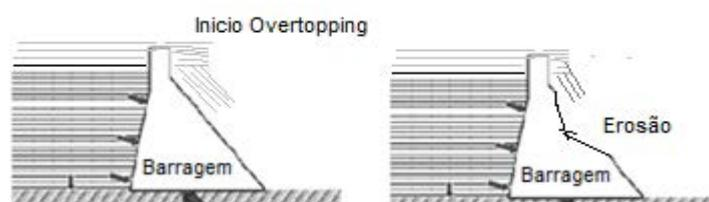
**Figura 11:** Modelo de Galgamento em barragem (Mod. PRICE, 2009).
