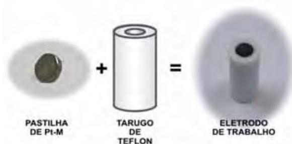
Figura 08: Representação da montagem dos eletrodos intermetálicos.
