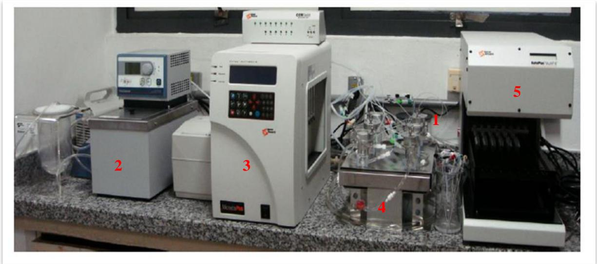
Figura 20. Equipamento Microette (Hanson Corporation) constituído Célula de Difusão de Franz. Onde: 1- Béquer jaquetado onde se armazena o meio receptor em temperatura constante; 2- Banho de água com temperatura constante; 3- Equipamento Microette; 4- Aparato com 6 células de Franz; 5- Amostrador. (Foto tirada pela autora).
