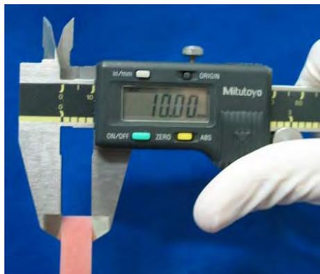
FIGURA 3- Mensuração do corpo-de-prova.
