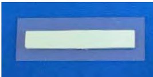
FIGURA 5- Réplica fixada sobre a lâmina de vidro.
