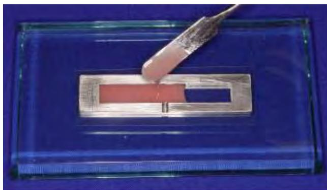
FIGURA 2- Inserção da resina no interior da matriz metálica.
