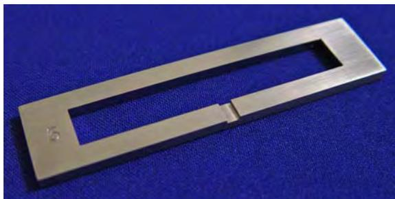
FIGURA 1- Matriz metálica vazada.
