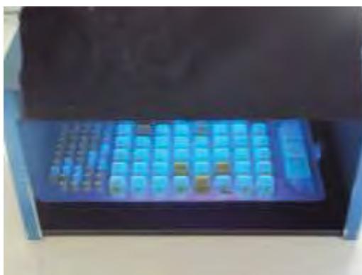
**Figura 7.** Presença de *E. coli* indicada pela fluorescência das celas do sistema Colilert onde foram colocadas amostras das águas de coletas.
