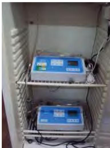
**Figura 6.** Aparelho utilizado para incubação da amostra marca Hach, modelo BOD Trak™
