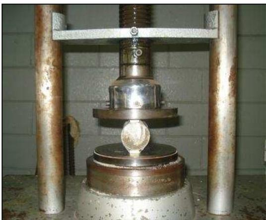
**Figura 24** - Posicionamento do CP para ensaio à tração por compressão diametral.
