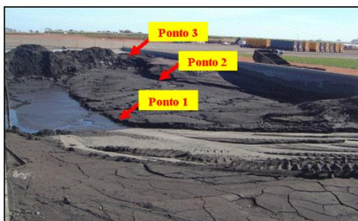
**Figura 11** - Pontos 1, 2 e 3 de coleta das cinzas CBC1, CBC2 e CBC3, respectivamente, da lagoa de decantação da Usina Interlagos.
