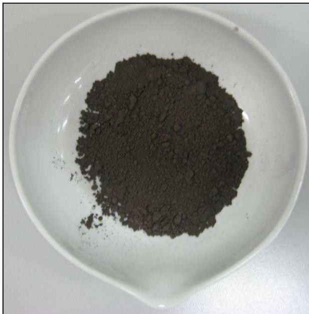
**Figura 29** - Aspecto da cinza do bagaço de cana usada na composição das argamassas
