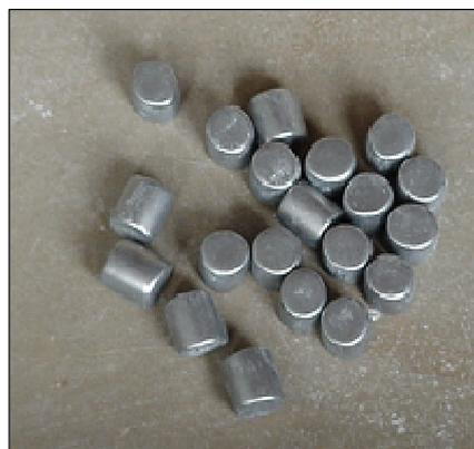
**Figura 23** – Cilindros de aço que compõem o moinho.
