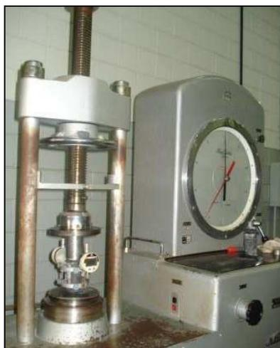
**Figura 26** - Corpo-de-prova instalado na prensa hidráulica com os relógios comparadores.
