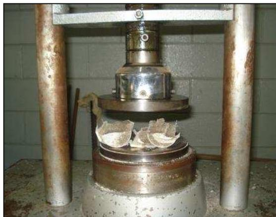
**Figura 25** - Ruptura do CP à tração por compressão diametral.
