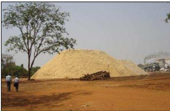
**Figura 18** - Bagaço de cana que é utilizado para a produção de vapor.
