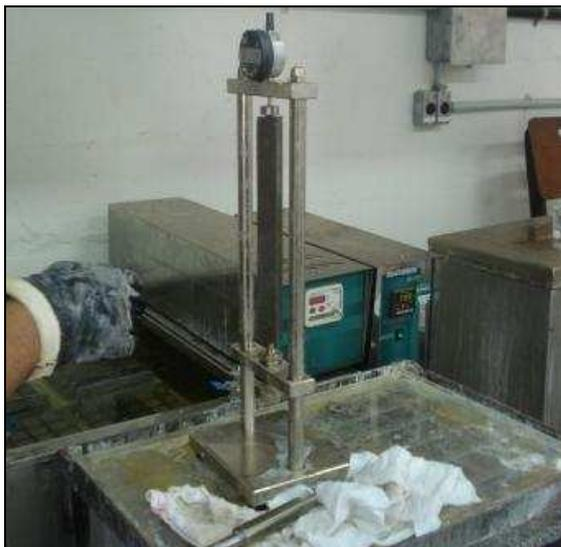
**Figura 27** - Medição da expansão da barra de argamassa devido à reatividade do agregado.
