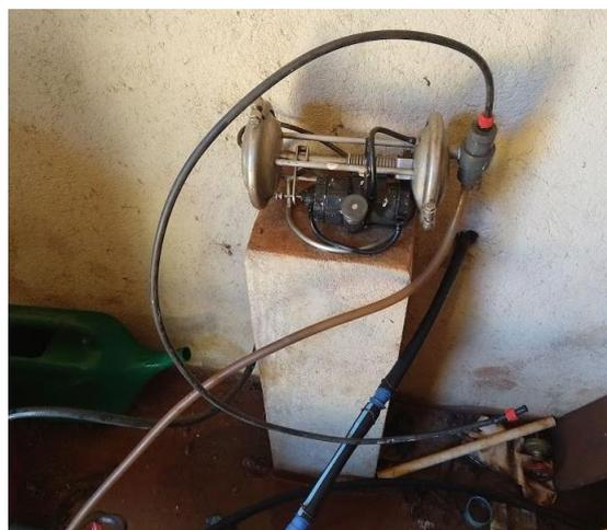
Figura 3. Injeção de fertilizantes na irrigação.
