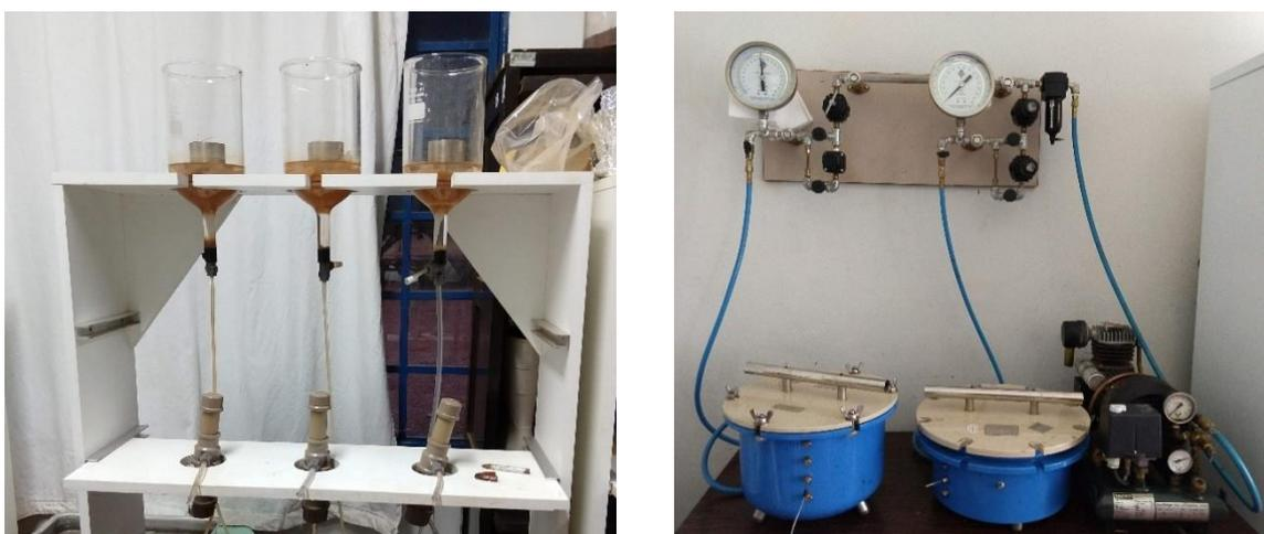
Figura 5. Funil de Haines e extrator de Richards utilizados na determinação da curva característica de retenção de água no solo.
