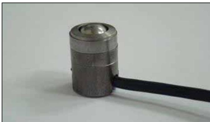
**Figura 4.4** – Célula de carga.
