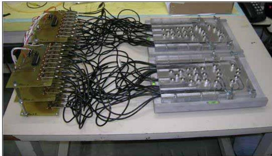
**Figura 4.3-** Foto das plataformas de força e placas dos circuitos eletrônicos.
