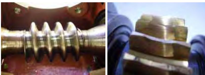
Figura 4.40 – Elementos internos do redutor de velocidades após o segundo ensaio.
