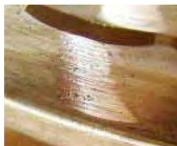
Figura 4.8 – Foto mostrando o desgaste na coroa após o segundo teste (com óleo ISO 68).
