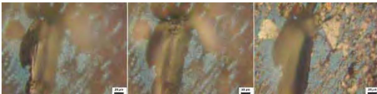
Figura 4.31 - Partículas de desgaste geradas na segunda semana do ensaio B. Fotos do anel interno do RPD.
