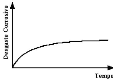
Figura 2.9 – Desgaste corrosivo x Tempo: como formação de filme na superfície (RABINOWICZ, 1980).
