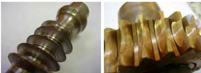
Figura 4.47 – Elementos internos do redutor de velocidades após o terceiro ensaio.
