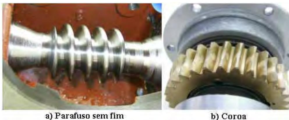
Figura 4.9 – Elementos internos do redutor de velocidades.
