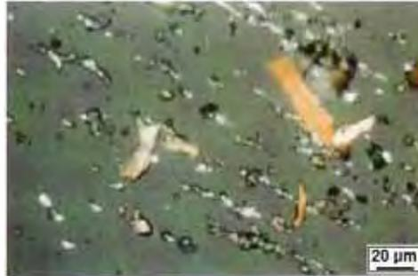
Figura 2.27 – Partículas de cobre vista em microscópio ótico (KITTIWAKE, 2004).
