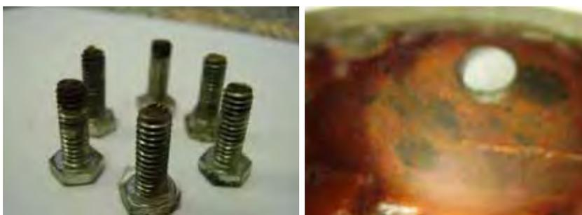
Figura 4.41 – Oxidação dos parafusos e da caixa do redutor.
