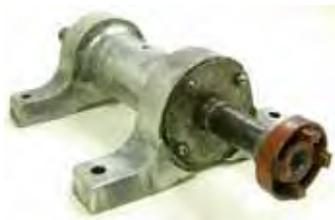
Figura 3.2 – Mancal utilizado na montagem da bancada.
