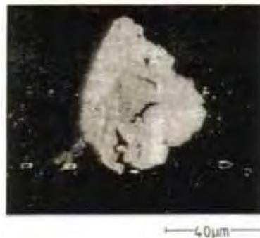
Figura 2.26 – Partículas laminares causadas por fadiga de rolamento vista em microscópio ótico (KITTIWAKE, 2004).
