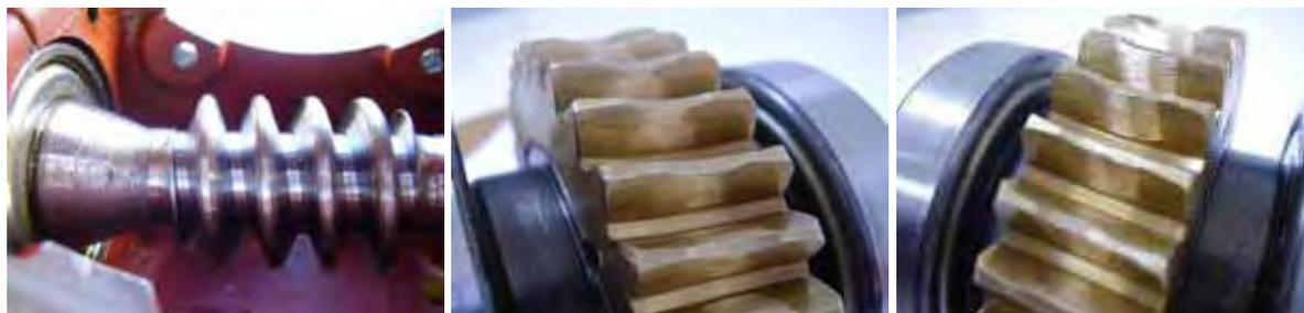
Figura 4.25 – Elementos internos do redutor de velocidades após o primeiro ensaio.
