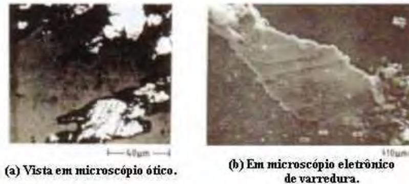
Figura 2.22 – Partículas típicas do desgaste severo por deslizamento. As partículas exibem estrias na superfície (KITTIWAKE, 2004).
