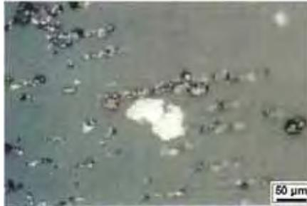
Figura 2.31 – Partícula de alumínio vista em microscópio ótico (KITTIWAKE, 2004).
