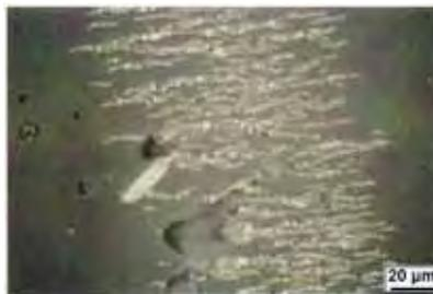
Figura 2.30 – Partícula de níquel vista em microscópio ótico (KITTIWAKE, 2004).
