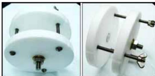
**Figura 6:** Célula eletroquímica com 2 eletrodos em formato de placas separados entre si por uma membrana porosa de tecido-não-tecido (TNT) ou por *O-rings*, usada nas medidas de EIS e ENA em biodiesel produzido a partir de óleo de soja.
