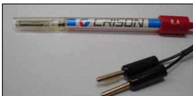
**Figura 4:** Célula de condutividade da marca CRISON, constante de célula igual a  $0,09 \text{ cm}^{-1}$ , utilizada nas medidas de teste de potenciostato usando biodiesel produzido a partir de sebo animal e a partir de óleo de soja.
