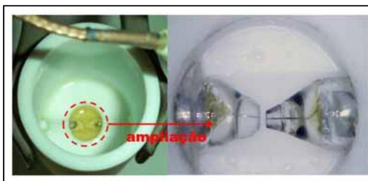
**Figura 5:** Célula eletroquímica para posicionar 2 eletrodos frente a frente, usada nas medidas de teste de potenciostato usando biodiesel produzido a com sebo animal.
