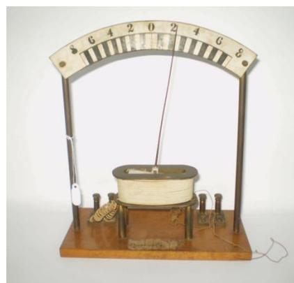
Figura 37 – Galvanômetro
