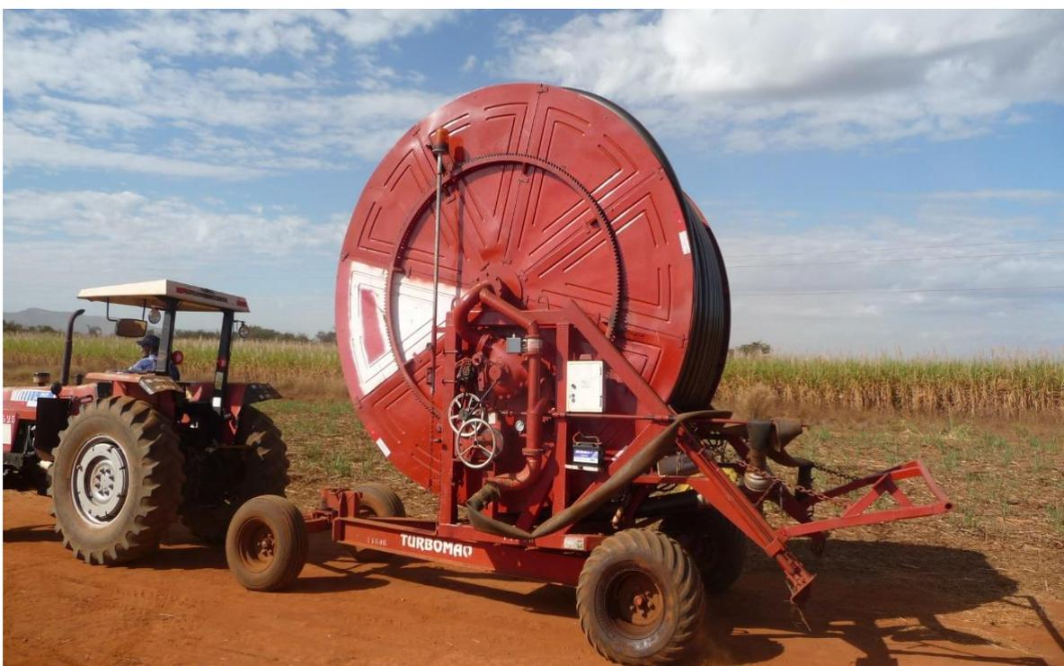
**Figura 24.** Equipamento de irrigação autopropelido.
