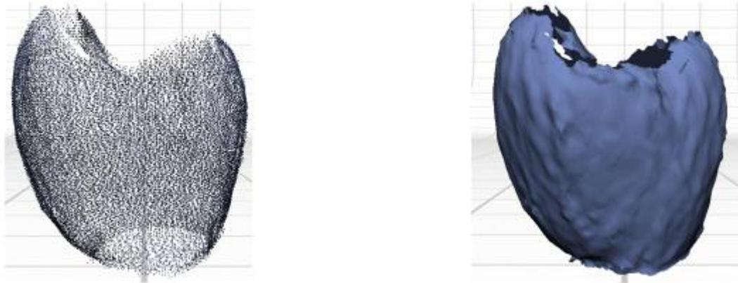
Figura 3.3: (a) Nuvem de pontos gerada pelo escaneamento e (b) superfície gerada.
