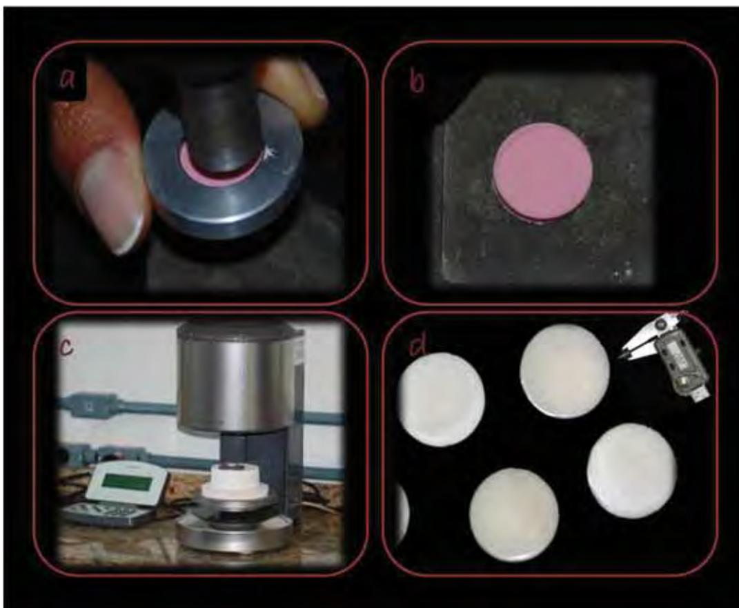
Figura 5 – (a) Remoção da amostra da matriz; (b) amostra antes da sua sinterização; (c) forno para sinterização da amostra; e (d) amostra após a sinterização e paquímetro conferindo sua espessura após polimento.
