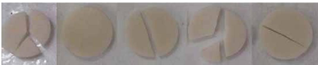
Figura 27 – CP representativos do grupo  $V7_{\text{HF/NG10}}$  testados em resistência à compressão.
