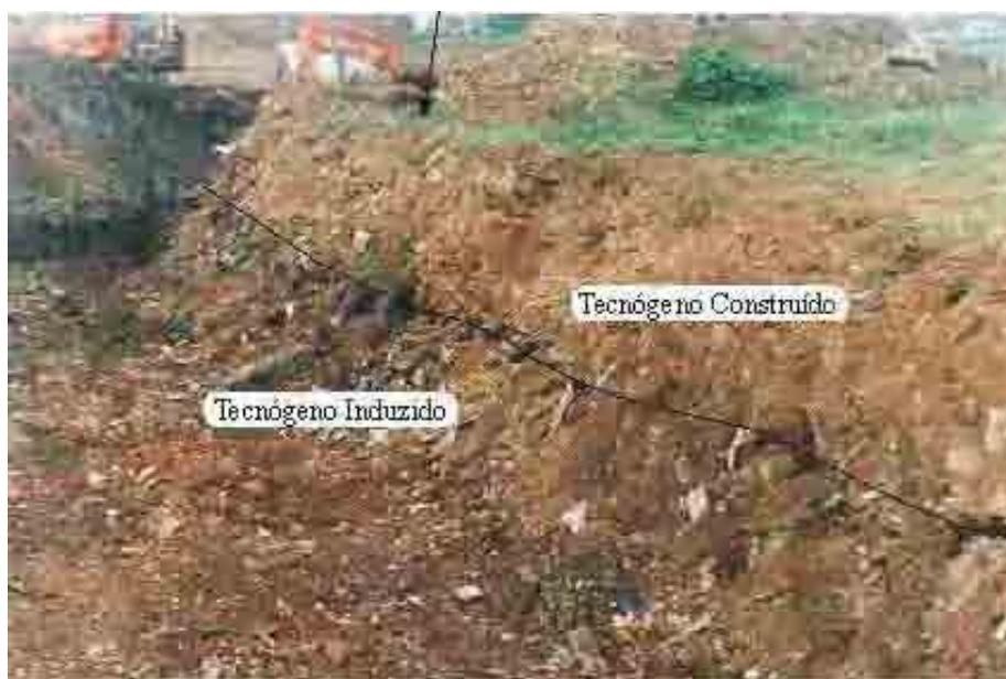
FOTO 7.4 Detalhe da trincheira/vala evidenciando os depósitos tecnógenos construído e induzido, este último mascarado pela grande quantidade de rejeitos tecnogênicos.
