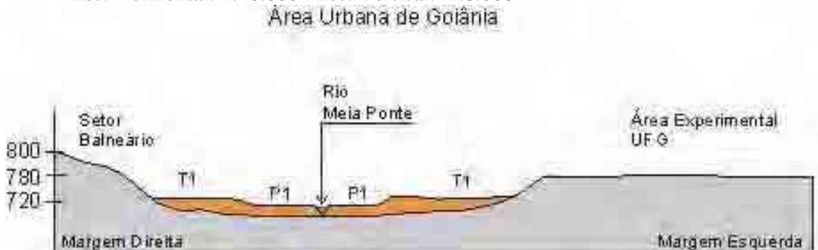
FIGURA 6.74 – Perfil transversal identificando a planície de inundação atual e Terraço T1
