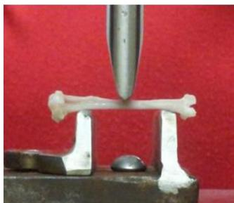
Figura 6: Ensaio mecânico de flexão de três pontos. Fonte: PERES-UENO, MJ. 2015.
