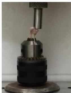
Figura 7: Ensaio mecânico de compressão no colo femoral. Fonte: PERES-UENO, MJ. 2015.
