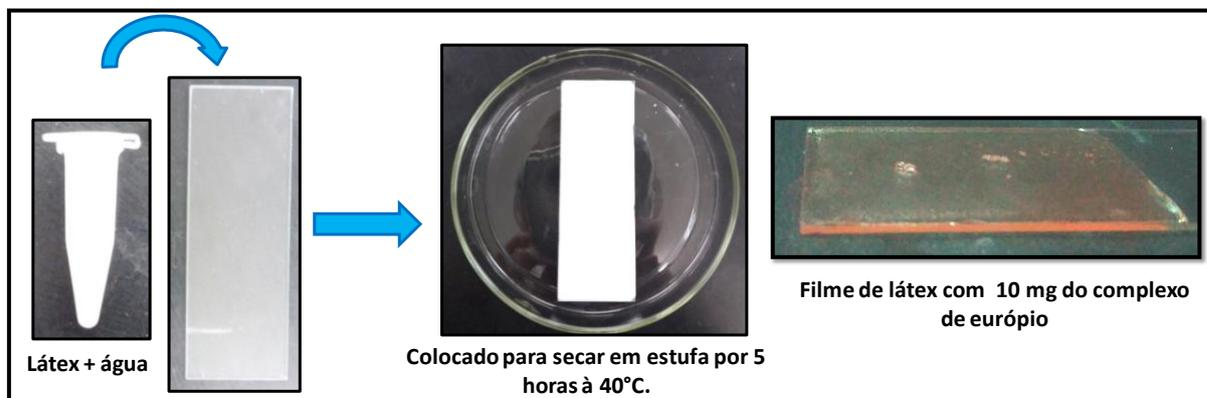
Figura 21: Esquema do processo de obtenção dos filmes de látex.
