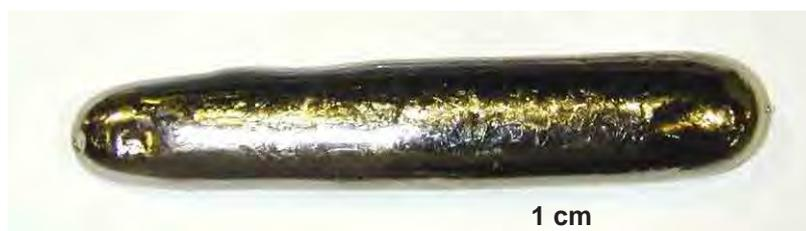
**Figura 5.** Lingote resultante da fusão a Arco.
