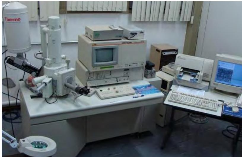
Figura 6 - Microscópio Eletrônico de Varredura (JEOL – JSM- T330A, Jeol Ltda, Tokyo Japão). (Gentileza e permissão da mestra Nádia de Souza Ferreira).
