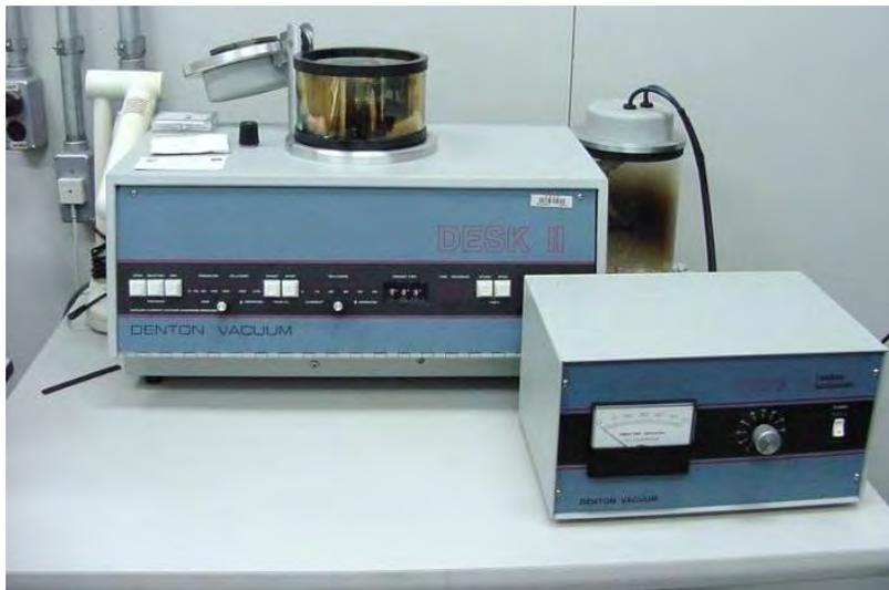
Figura 8 – Metalizadora para aplicação de ouro nos espécimes (Desk II, Denton Vacuum, JEOL Ltda, Tokyo, Japão). (Gentileza e permissão da mestra Nádia de Souza Ferreira).
