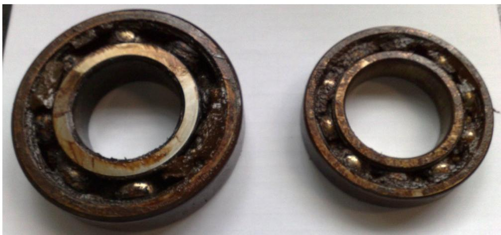
Figura 42 – Rolamentos do RM101, logo após a sua retirada do equipamento.
