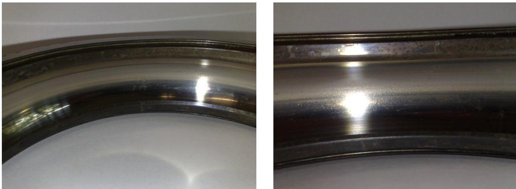
Figura 50 e 51 – Parte interna da pista externa do Rolamentos do RM101. A superfície com aparência de “jateado” se deve pelo atrito de partículas suspensas na graxa entre as esferas e a pista.
