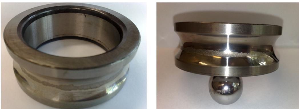
Figura 52 e 53 – Parte externa da pista interna do Rolamentos do RM101. Nota-se uma faixa com descamamento na parte “de baixo” do rolamento, por onde as esferas mantinham contato.
