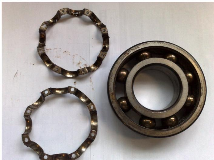
Figura 44 – Rolamento do LA do RM101, após a retirada da gaiola para desmontagem do mesmo.
