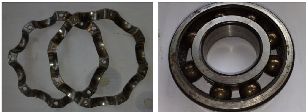
Figura 45 e 46 – Gaiola do rolamentos do RM101 em perfeito estado e as pistas e elementos rotantes do mesmo, prontos para desmontagem e avaliação interna.
