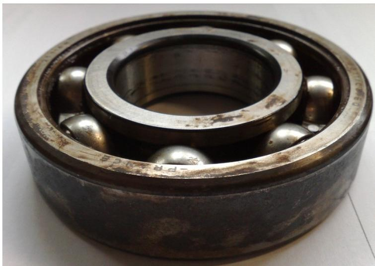
Figura 43 – Rolamento do lado acoplado (LA) do RM101, após sua limpeza para avaliação.
