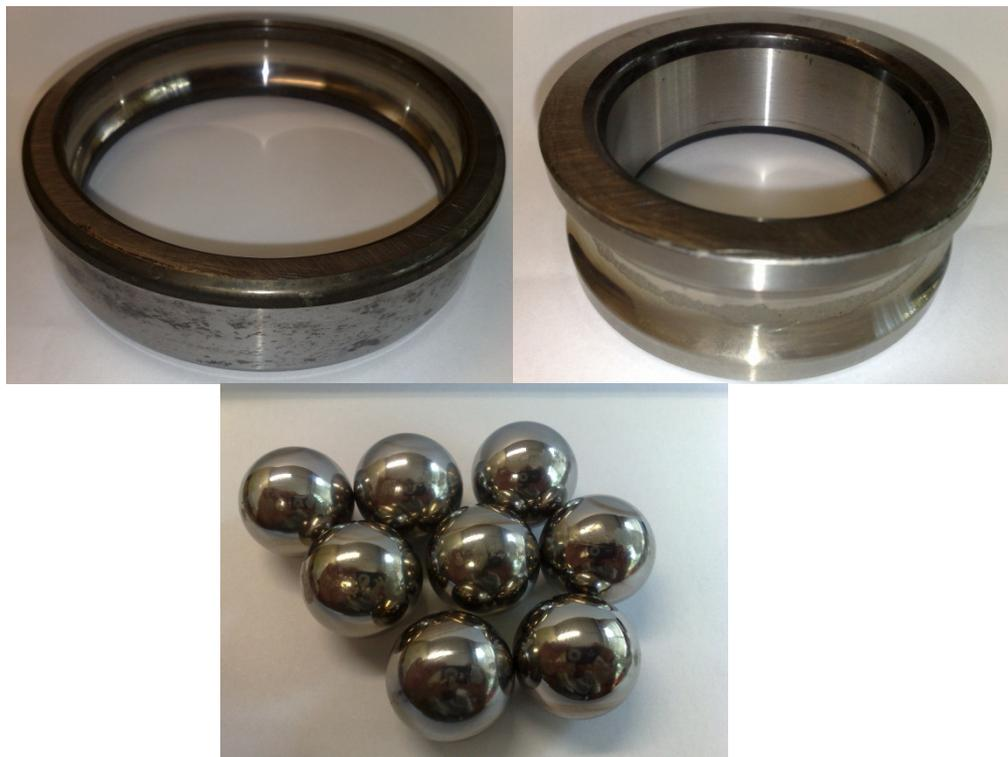
Figura 47, 48 e 49 – Rolamentos do RM101 desmontado.
