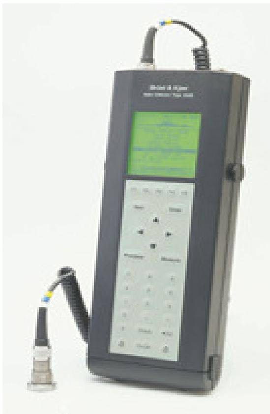
Figura 12 – Foto do coletor de dados Brüel & Kjær, em conjunto com o sensor de aceleração.
