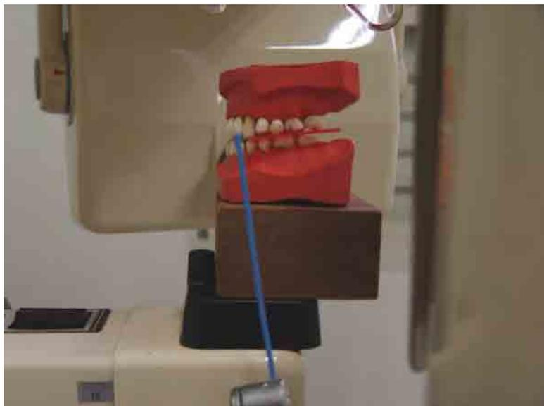
FIGURA 3– Fotografia do manequim acomodado ao aparelho radiográfico panorâmico *PANOURA 10* com plano oclusal paralelo ao horizontal.
