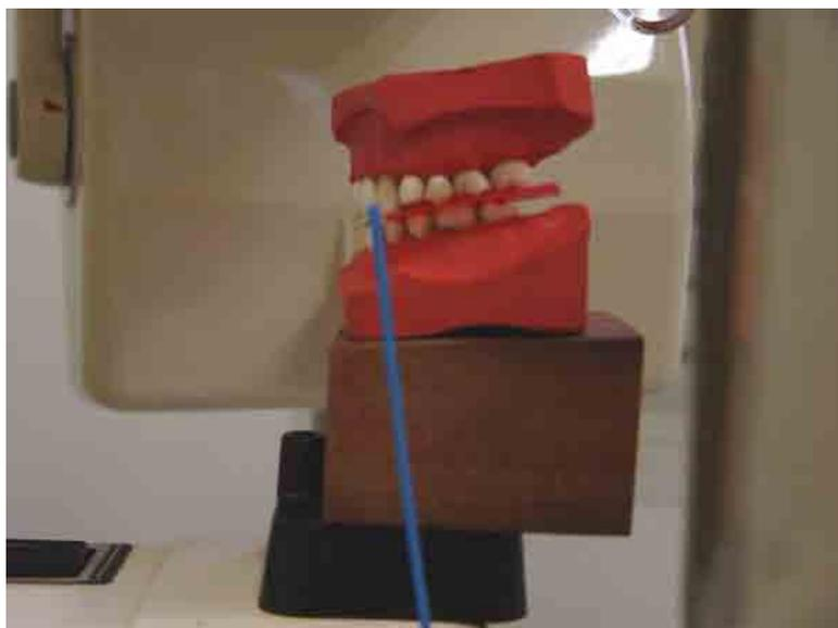
FIGURA 5– Fotografia do manequim acomodado ao aparelho radiográfico panorâmico *PANOURA 10* com plano oclusal à +5 graus em relação ao plano horizontal.
