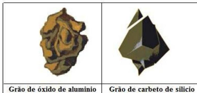
**Figura 5-**Formato geométrico dos grãos abrasivos
