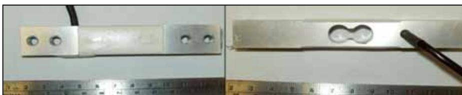
**Figura 12**-Célula de carga modelo TBSPL
