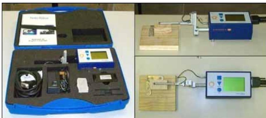
**Figura 17**-Rugosímetro da marca TAYLOR HOBSON, modelo Surtronic 25+
