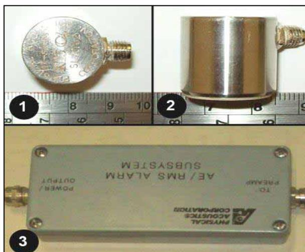
**Figura 18**-Módulo de emissão acústica, sensor (1) (2) e amplificador (3)
