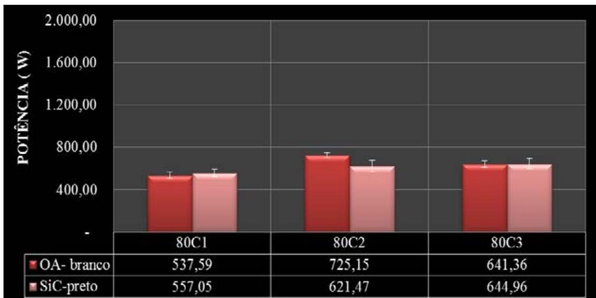
Figura 23-Gráfico relacionando a potência de lixamento com as condições da lixa granulometria de 80 mesh
