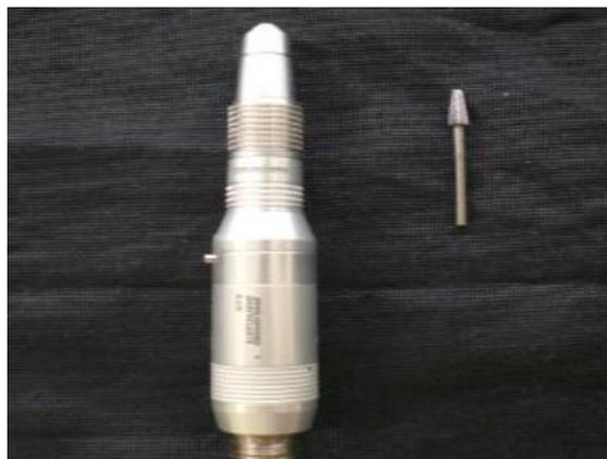
Figura 6 – Peça reta e ponta de acabamento (*Maxicut*) para acabamento de corpos de prova
