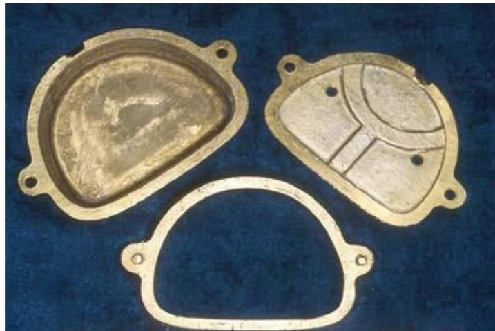
Figura 4 – Mufla metálica para prensagem de resina acrílica polimerizada por banho de água quente.
