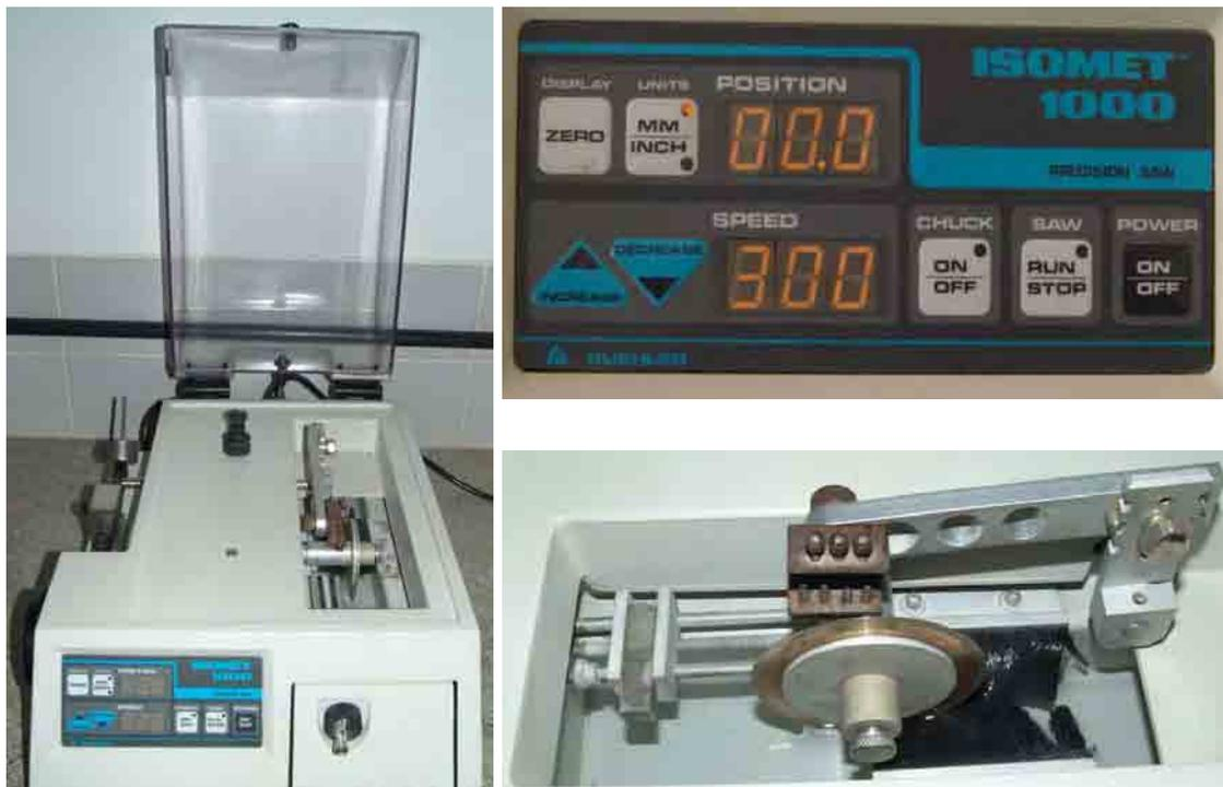
*FIGURAS 9a, 9b, 9c – Máquina de corte, painel de controle e disco diamantado para o corte.*
