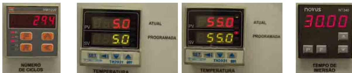
*FIGURAS 8a, 8b, 8c, 8d – Painéis da máquina de ciclagem: número de ciclos, temperaturas mínima e máxima e tempo de imersão.*
