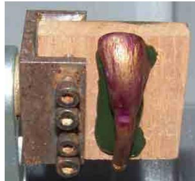
*FIGURAS 10a, 10b – Dente fixado na base de madeira para ser cortado.*
