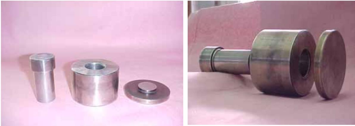
**Figura 13** - Molde de fabricação dos discos dinâmicos em prensa
