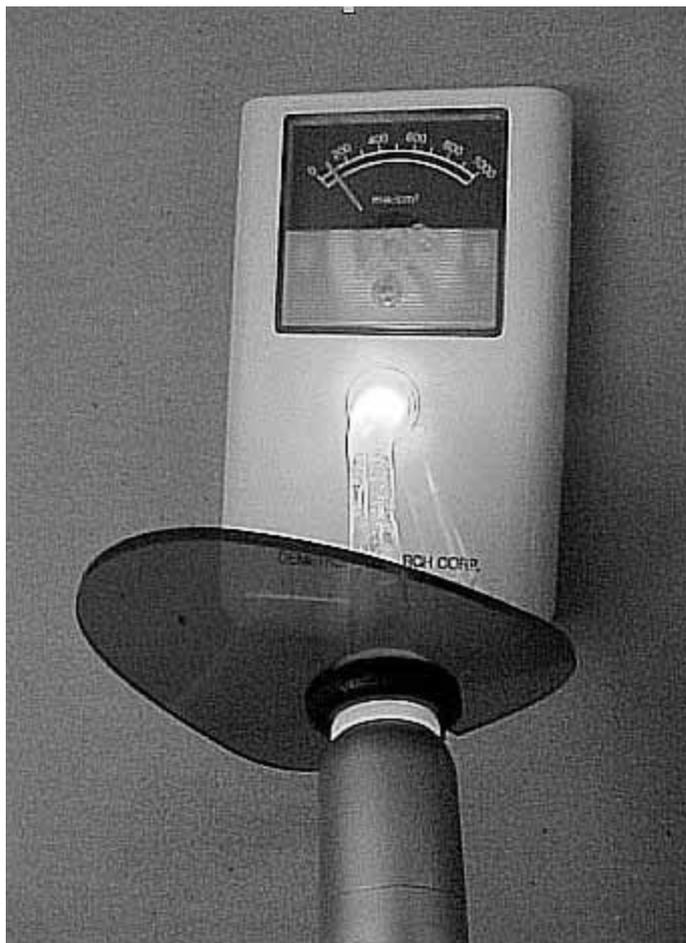
**Figura 21** - O fotopolimerizador de LED sendo aferido.
