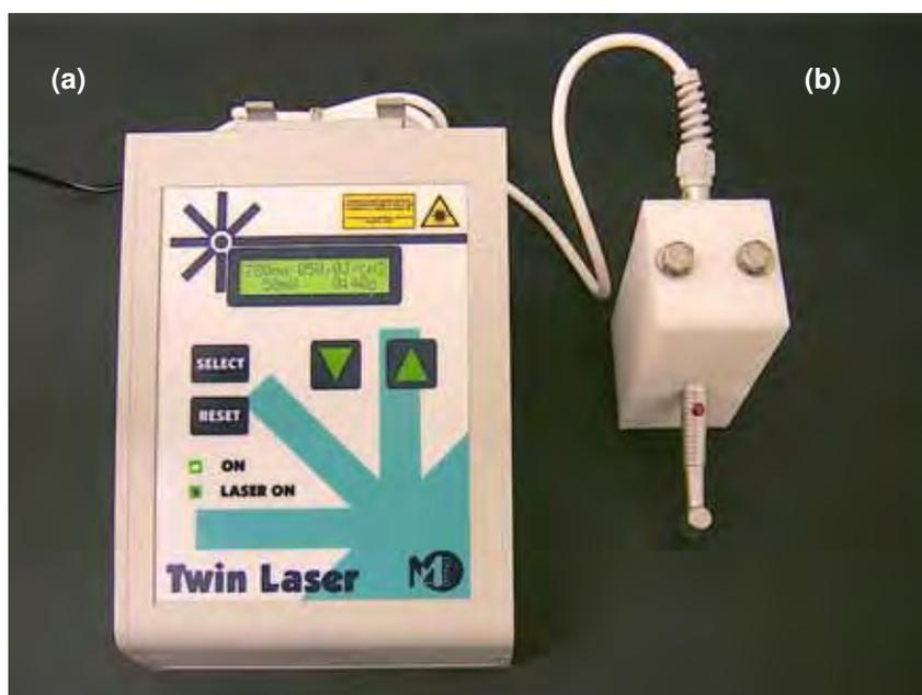
**Figura 1B.** Equipamento de Laser Twin Laser (MM Optics<sup>®</sup> LTDA, São Carlos, São Paulo, Brasil) utilizado nos experimentos. (a) painel frontal com visor indicando potência, tempo, dosagem e tipo de caneta; botões para seleção de funções e ajuste de parâmetros. (b) suporte em teflon adaptado com caneta emissora de laser infra-vermelha acoplada.
