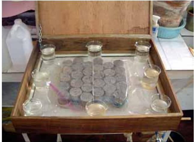
Figura 10. Mesa de tensão utilizada para os potenciais matriciais de  $\bar{\psi}$ 0,004 e  $\bar{\psi}$ 0,006 MPa (a).
