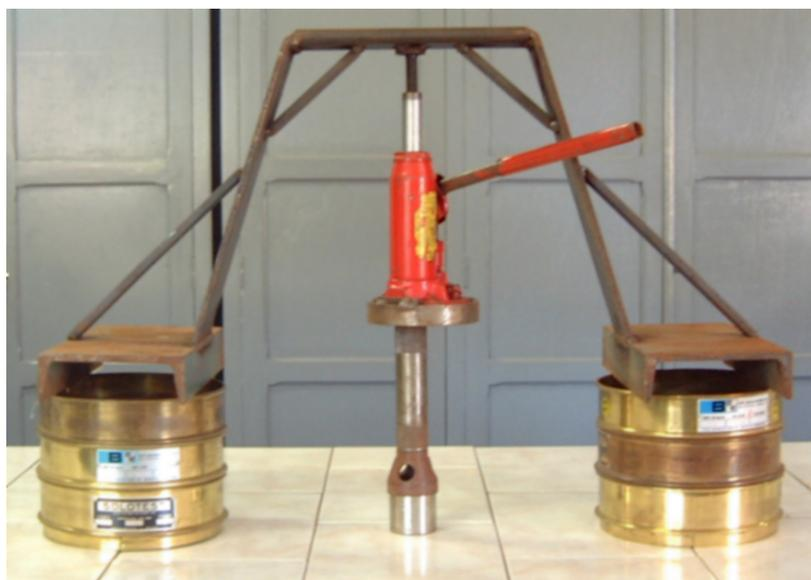
Figura 9. Aparato para coleta de amostras de solo com estrutura indeformada.
