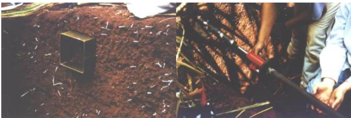
Figura 7. Amostrador de raízes (0,10 x 0,10 x 0,10 m). Figura 8. Inserção do amostrador com auxílio de suporte e macaco hidráulico.
