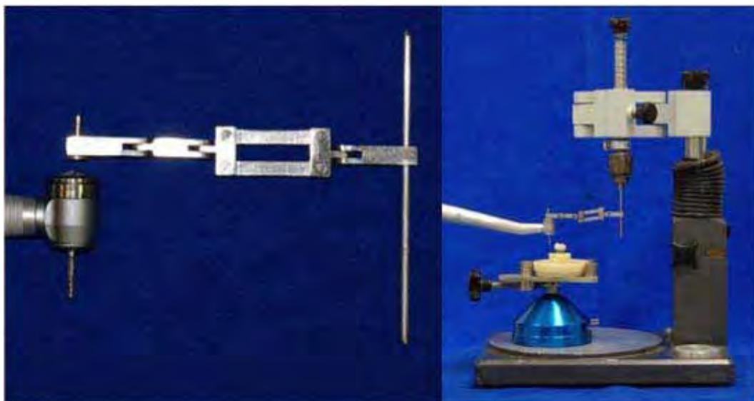
Figura 4– Dispositivo utilizado para padronização dos preparos
