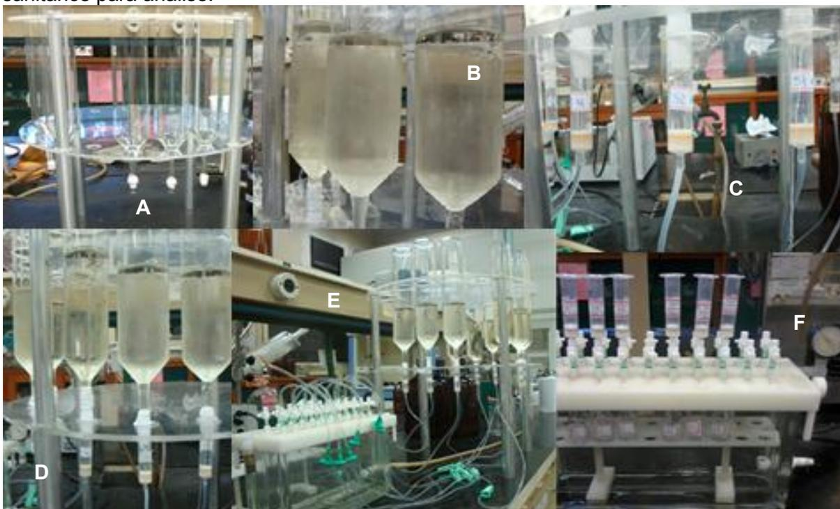
Arranjo experimental: (a) suporte para filtração; (b) amostra de esgoto sanitário; (c) cartuchos C-18; (d) cartuchos C-18 conectado ao reservatório amostral; (e) manifold conectado nos cartuchos C-18; (f) clean up.
