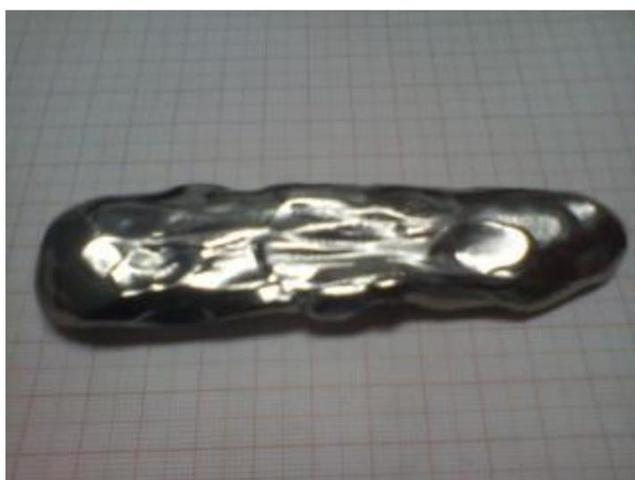
*Figura 3 – Lingote da liga Ti-15%pNb obtido por fusão em forno arco-voltaico*
