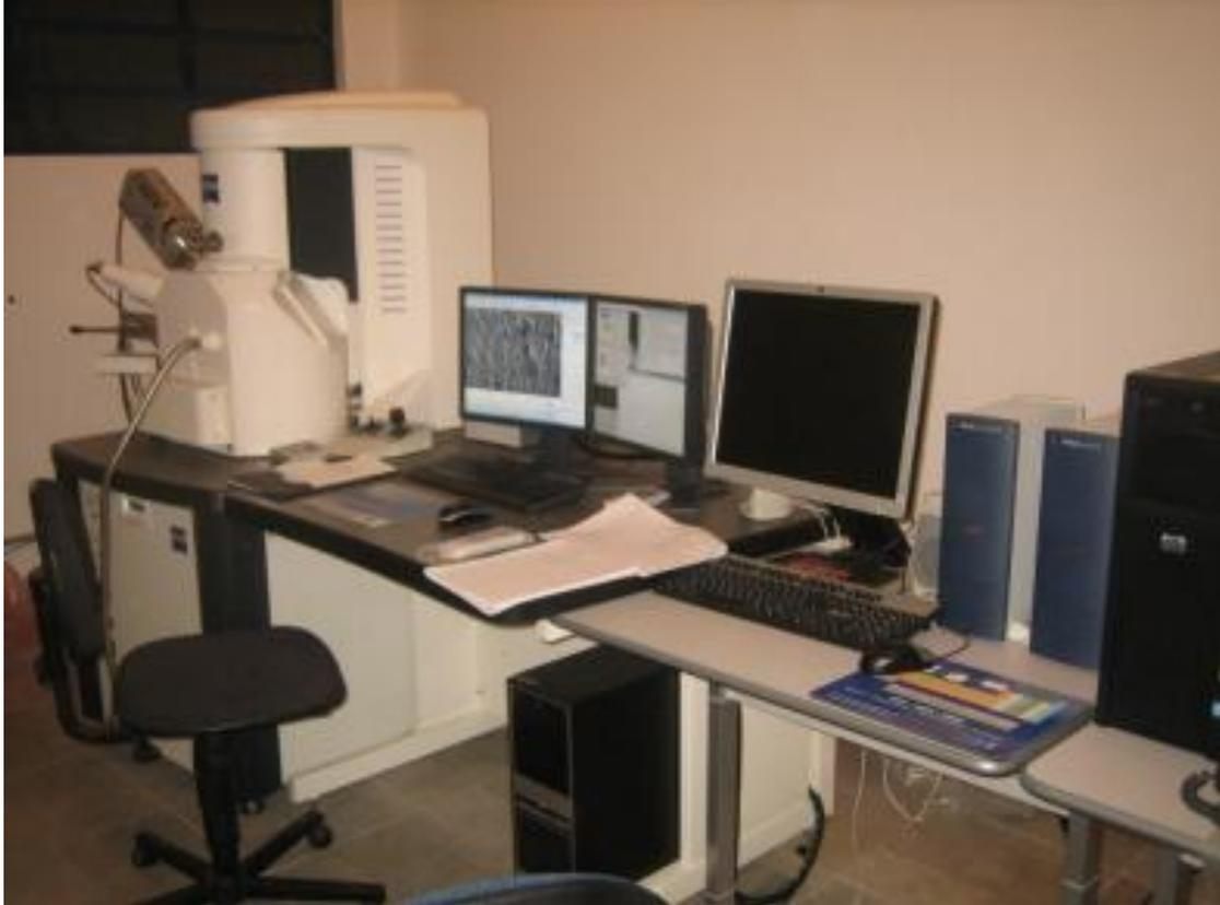
*Figura A12 – Microscópio Eletrônico de Varredura*
