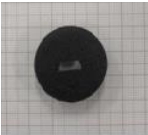
*Figura 7 – Fotografia de uma amostra embutida em baquelite*
