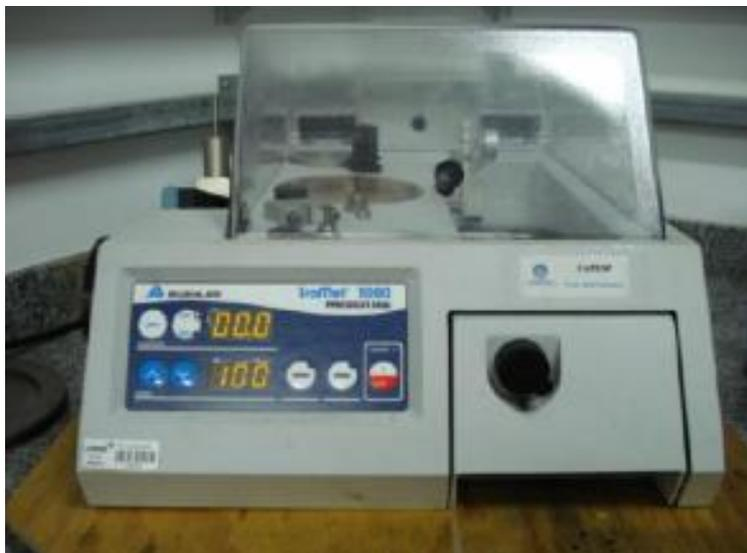
*Figura A2 - máquina de corte de precisão utilizada*
