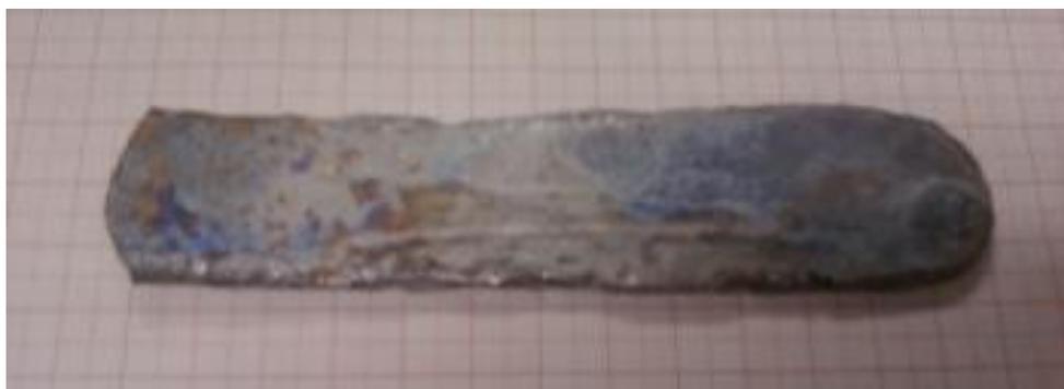
*Figura 4 – Lingote da liga Ti-26%pNb após laminação*
