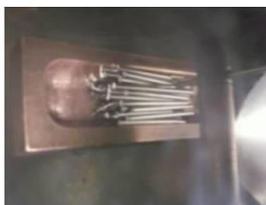
Figura A1 – Forno de fusão arco voltaico
