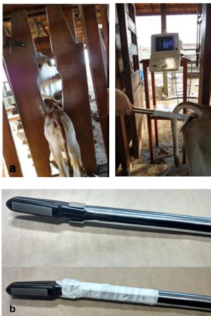
**FIGURA 1-** (a) Forma de contenção das bezerras com 18 dias de vida para acompanhamento com ultrassom dos ovários e útero de bezerras Nelore com o uso do (b) suporte do transdutor do ultrassom, desenvolvido e confeccionado em inox especificamente para este experimento.
