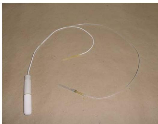
Figura 8. Extrator da solução montado. Nas extremidades das mangueiras colou-se “tripa-de-mico” para facilitar as conexões com a bomba a vácuo e com a seringa. Na mangueira que coleta a solução do solo foi acoplada a uma agulha de seringa, para atravessar a borracha, que veda o frasco coletor e não deixa que haja perda do vácuo.
