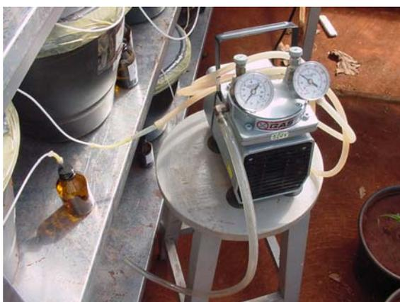
Figura 9. Bomba à vácuo acoplada a mangueira responsável em fazer vácuo na cápsula.
