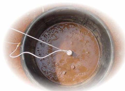
Figura 4. A cápsula porosa inserida no vaso em um tratamento saturado.
