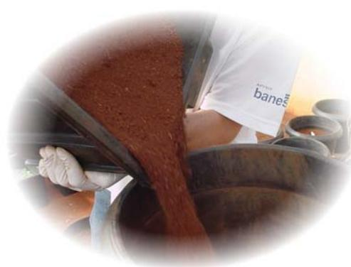
Figura 3. Homogeneização do solo e recolocação do mesmo no vaso.
