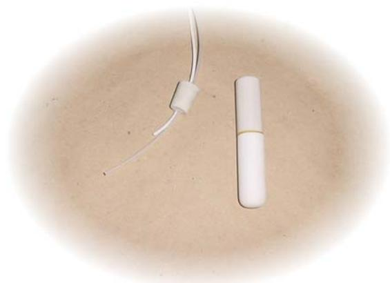
Figura 7. Cápsula de porcelana acoplada a um cano de PVC, e a tampa de borracha ao lado com as mangueiras responsáveis pelo vácuo na cápsula (mangueira mais curta) e coleta da solução (mangueira mais longa).
