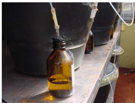
Figura 10. Coleta e armazenagem da solução do solo em um frasco de vidro escuro, hermeticamente fechado com um pedaço de borracha compacta e flexível.
