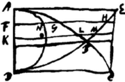
Si sint duæ semi-parabolæ [Fig. 9] quæcunque ad eundem axem sed contrario situ, ut ABC, DBE, et ducantur applicatæ communes FGH, KLM, eandem esse rationem rectanguli HFG ad MKL quæ est partium dictarum applicatarum, semicirculo super AD interceptarum, nempe quæ NF ad OK <sup>5)</sup>.
