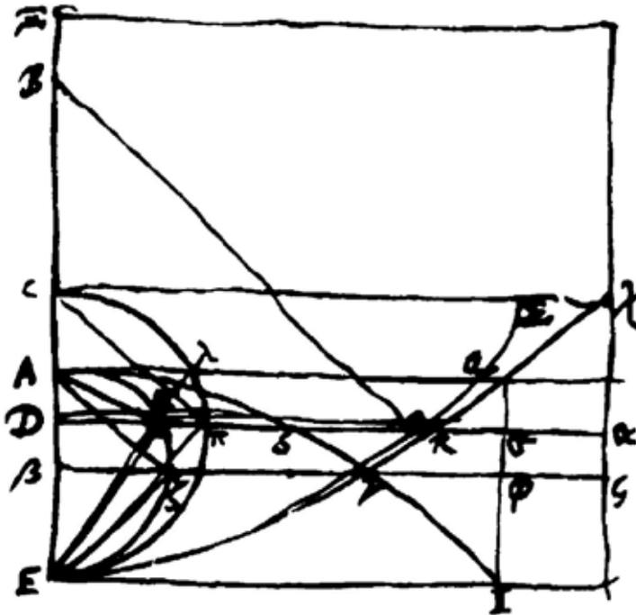
Ponimus mobile descendere per cycloidem ex puncto aliquo Q [Fig. 13] usque in E; et comparandum sit tempus hujus descensus cum tempore quo mobile cadit ex A in E motu naturaliter accelerato vel cum tempore huic æquali, quo nempe percurreret lineam AE motu æquabili et celeritate dimidia ejus quam acquirit in fine casus per AE.
