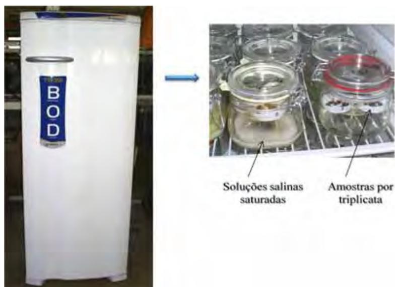
Figura 3.2. Adequação das amostras para a determinação das isotermas de sorção.
