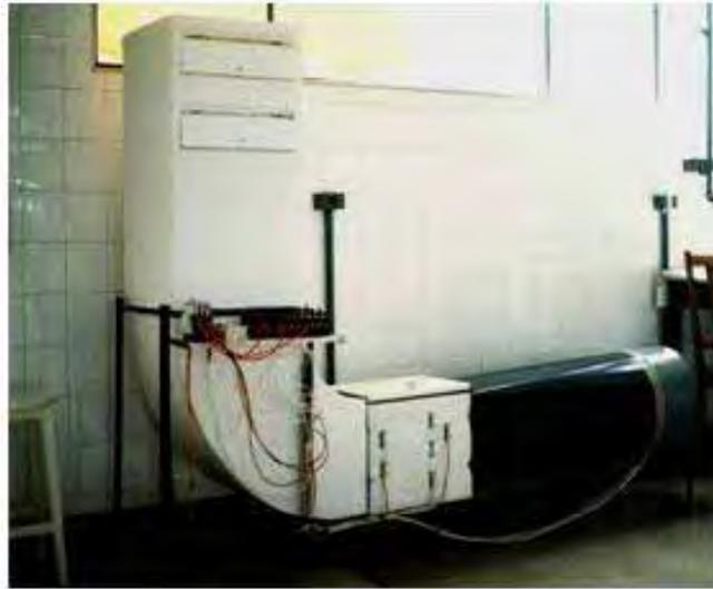
Figura 3.3. Secador convectivo de ar quente.
