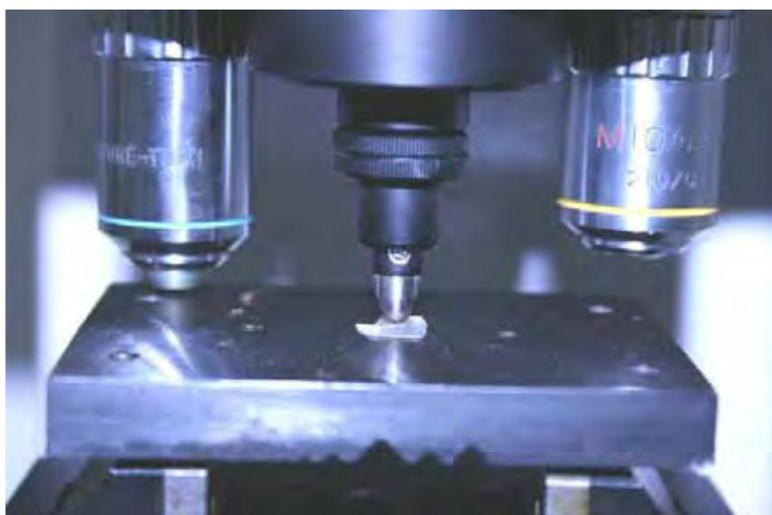
Figura 12 – Endentador de Vicker's posicionado na superfície polida da amostra.
