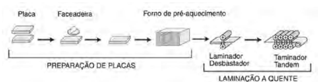
**Figura 6:** Processo de laminação à quente
