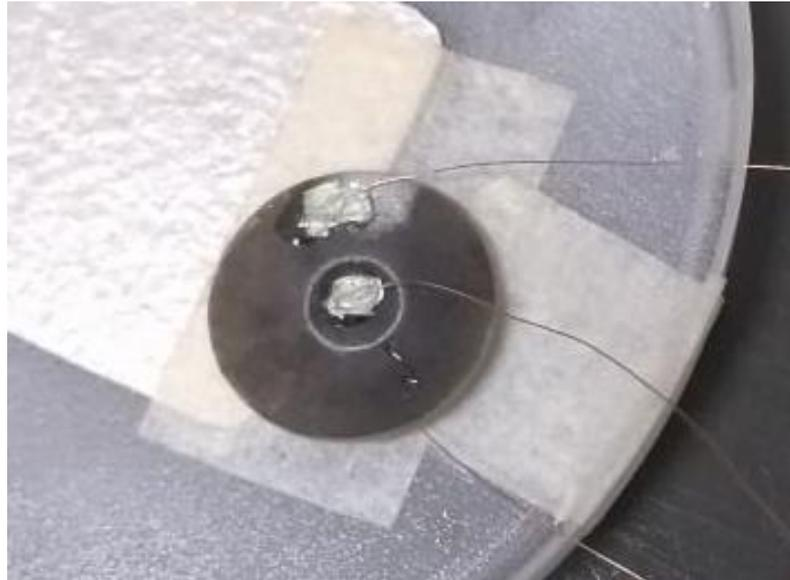
**Figura 17.** Foto da parte superior do transformador pronto, contendo os eletrodos de entrada e saída e os fios conectados para constituição dos dados experimentais.
