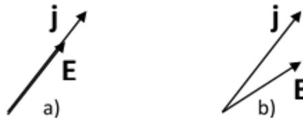
**Figura 29.** Diagrama de vetores para campo elétrico e densidade de corrente elétrica em a) um condutor isotrópico e; b) um condutor anisotrópico.
