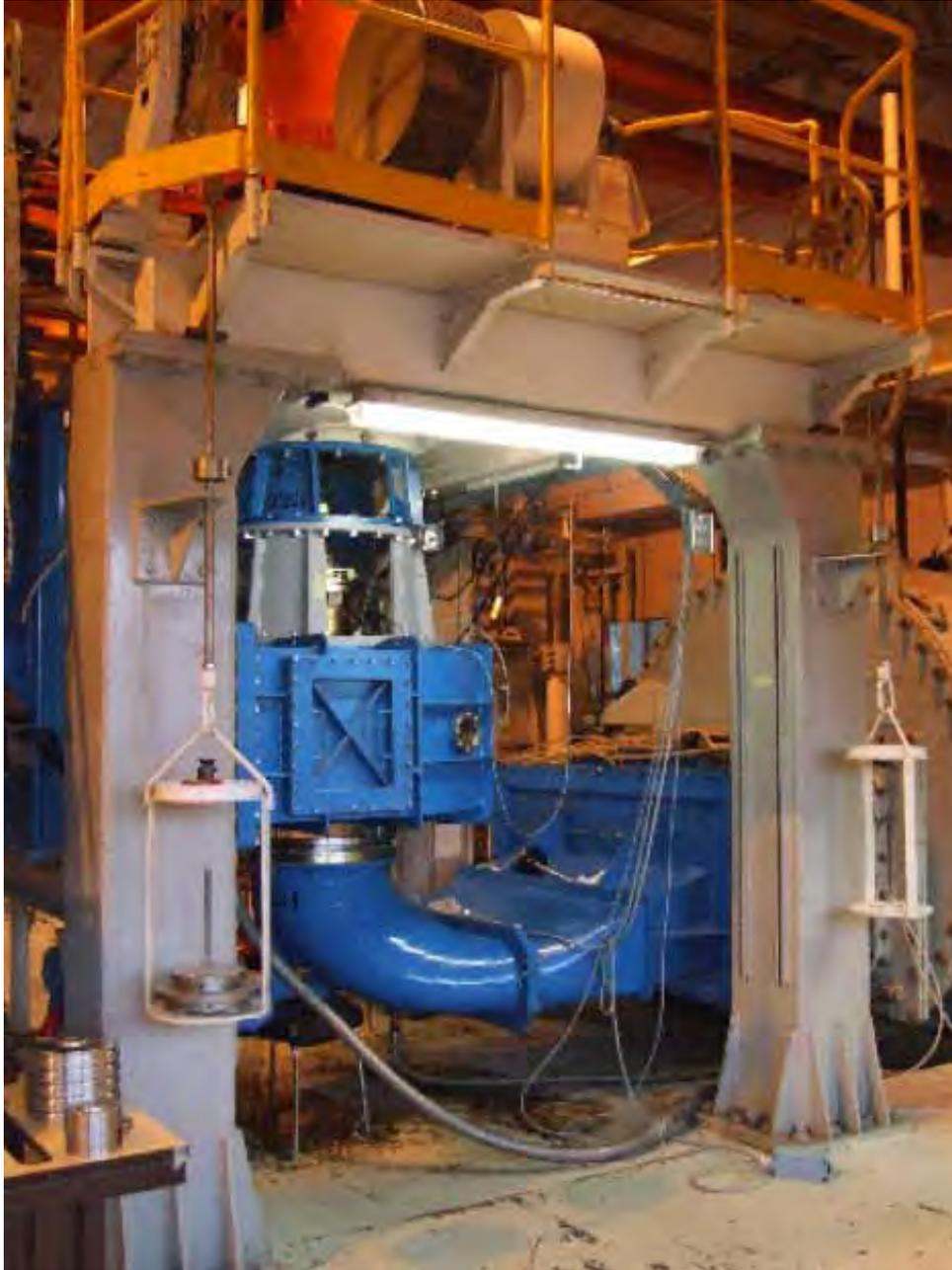
Figura 25 – Modelo reduzido para ensaios hidráulicos (Alstom, 2012).
