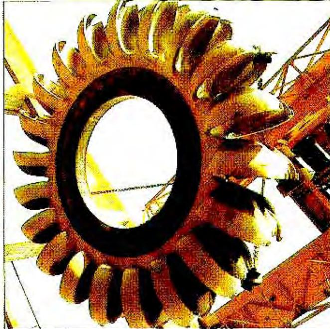
Figura 7 – Turbina do tipo Pelton (Alstom, 2012).
