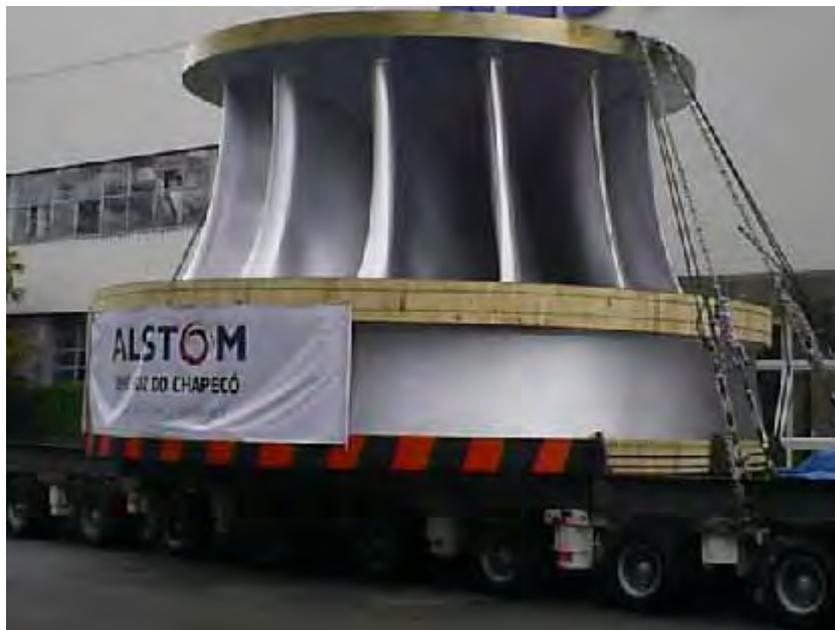
Figura 4 – Turbina do tipo Francis (Alstom, 2012).
