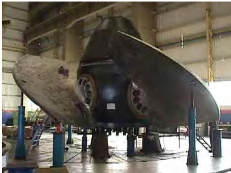
Figura 6 – Turbina do tipo Kaplan (Alstom, 2012).
