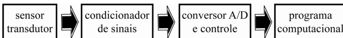
Figura 27 – Sistema de aquisição de dados.
