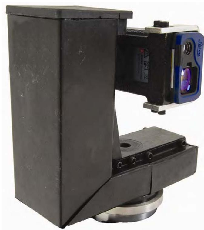
Figura 47 - Equipamento com proteção lateral e inferior.
