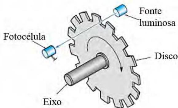
Figura 19 - Encoder óptico rotativo.
