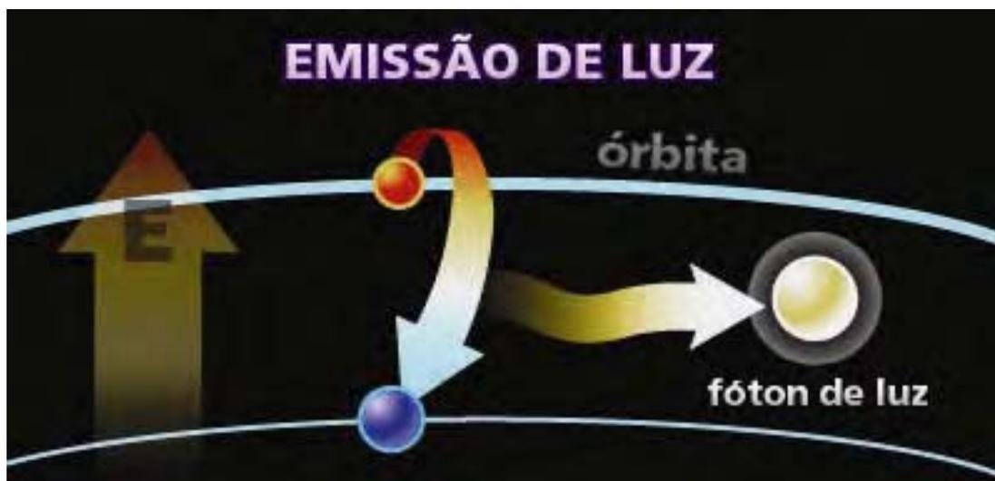
Figura 10 - Funcionamento do laser.
