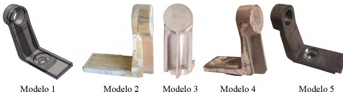
Figura 44 - Sequência de desenvolvimento das principais peças.
