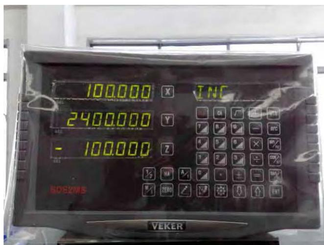
Figura 58 - Painel digital da fresadora ferramenteira Veker VK430-VP.
