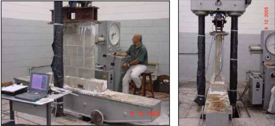
Figura 64 – Equipamento de ensaio das paredes.
