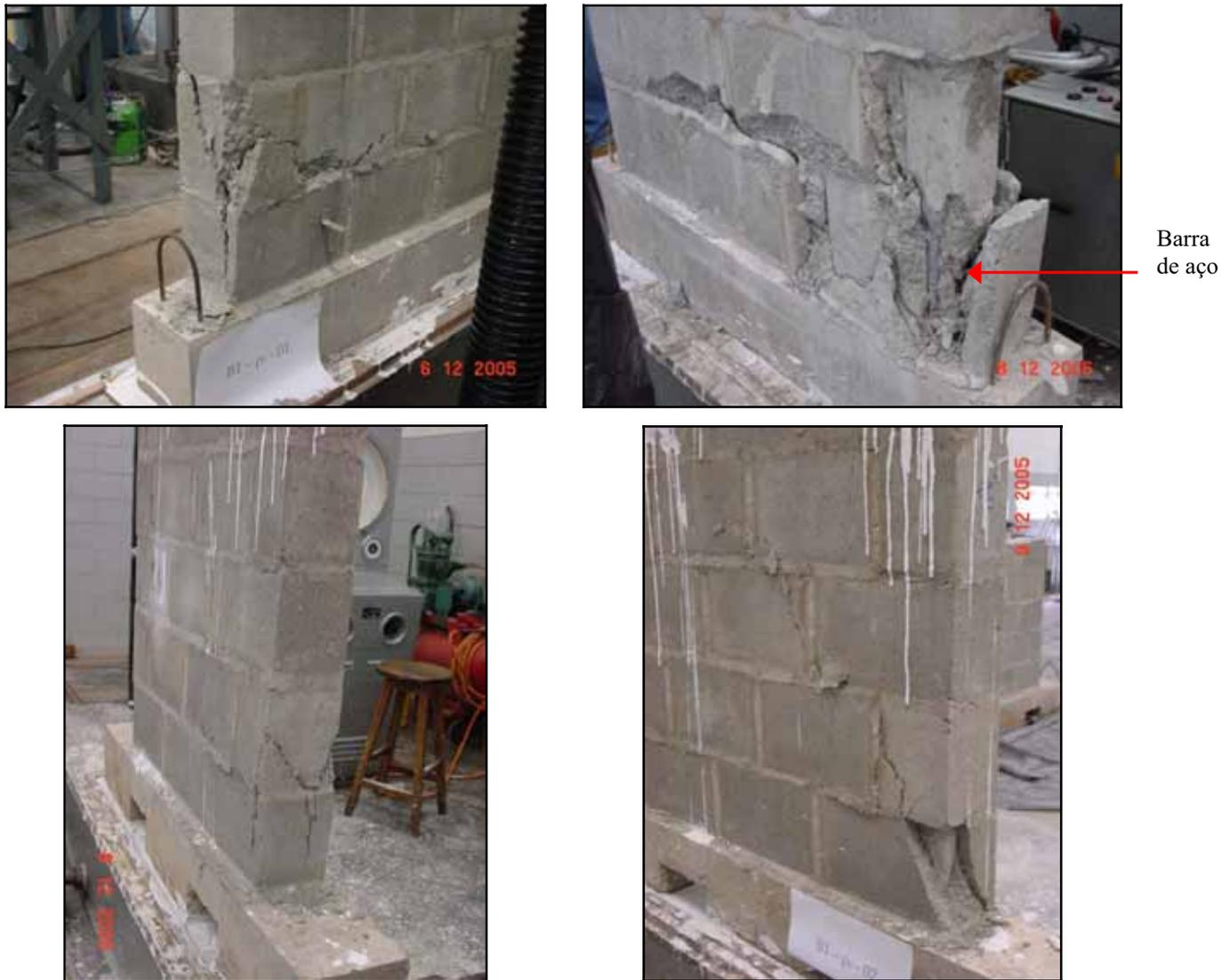
Figura 80 – Formas de ruínas das paredes B1-G1-Armadas.
