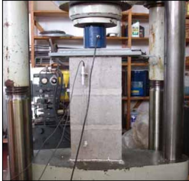
Figura 26 – Esquema de ensaio do prisma.
