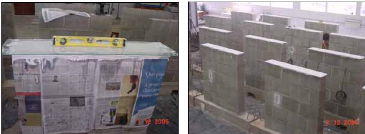
Figura 63 – Capeamento das paredes.
