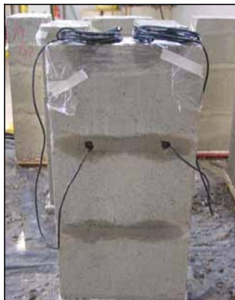
Figura 44 – Prisma instrumentado.
