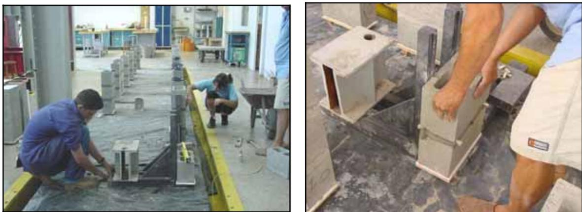
Figura 22 – Montagem dos prismas
