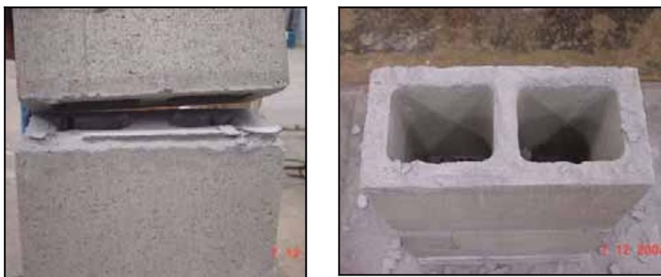
Figura 23 – Ruptura de prismas em ensaios pilotos
