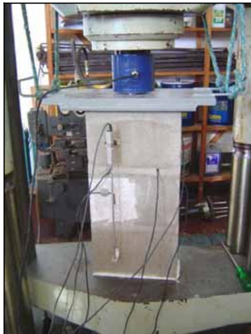
Figura 45 – Esquema de ensaios de prismas armados.
