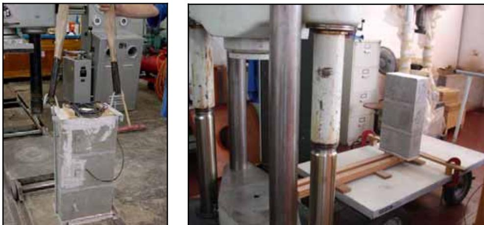
Figura 27 – Esquema de transporte dos prismas.
