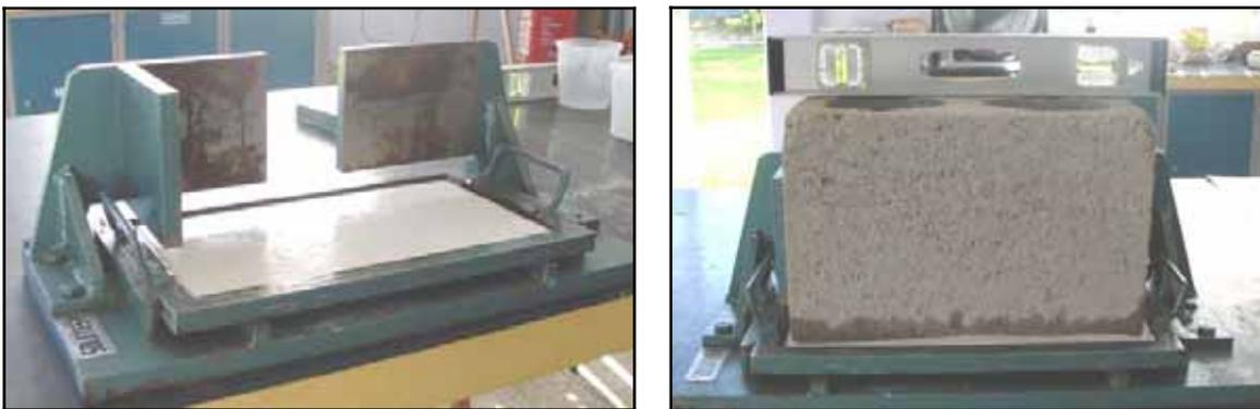
Figura 13 – Capeamento dos blocos.
