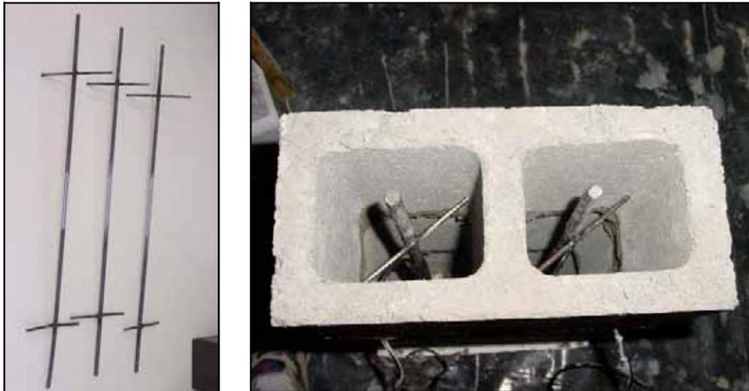
Figura 42 – Gabaritos de posicionamento das barras horizontais.
