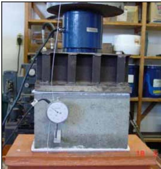
Figura 16 – Esquema de ensaio dos blocos.
