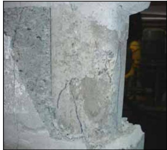
Figura 60 – Modo de ruptura dos Prismas  $\rho_3$ .
