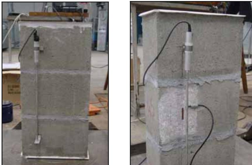
Figura 25 – Esquema de posicionamento dos LVDT's nos prismas.
