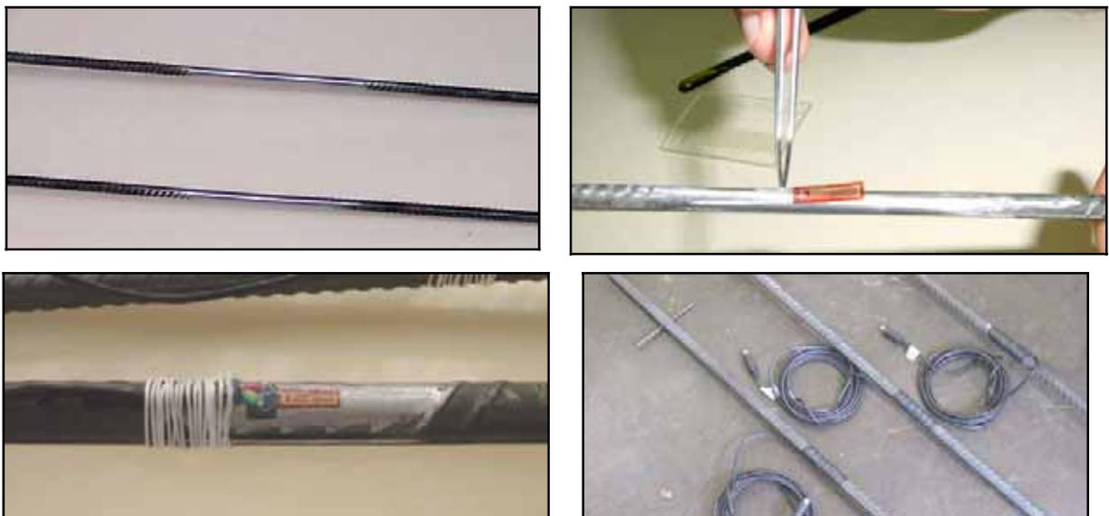
Figura 38 – Instrumentação das barras de aço.
