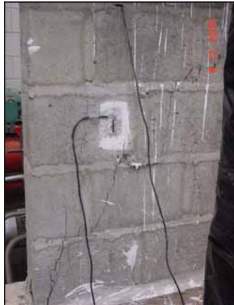
Figura 84 – Formas de ruínas das paredes B2-G1-Armadas.
