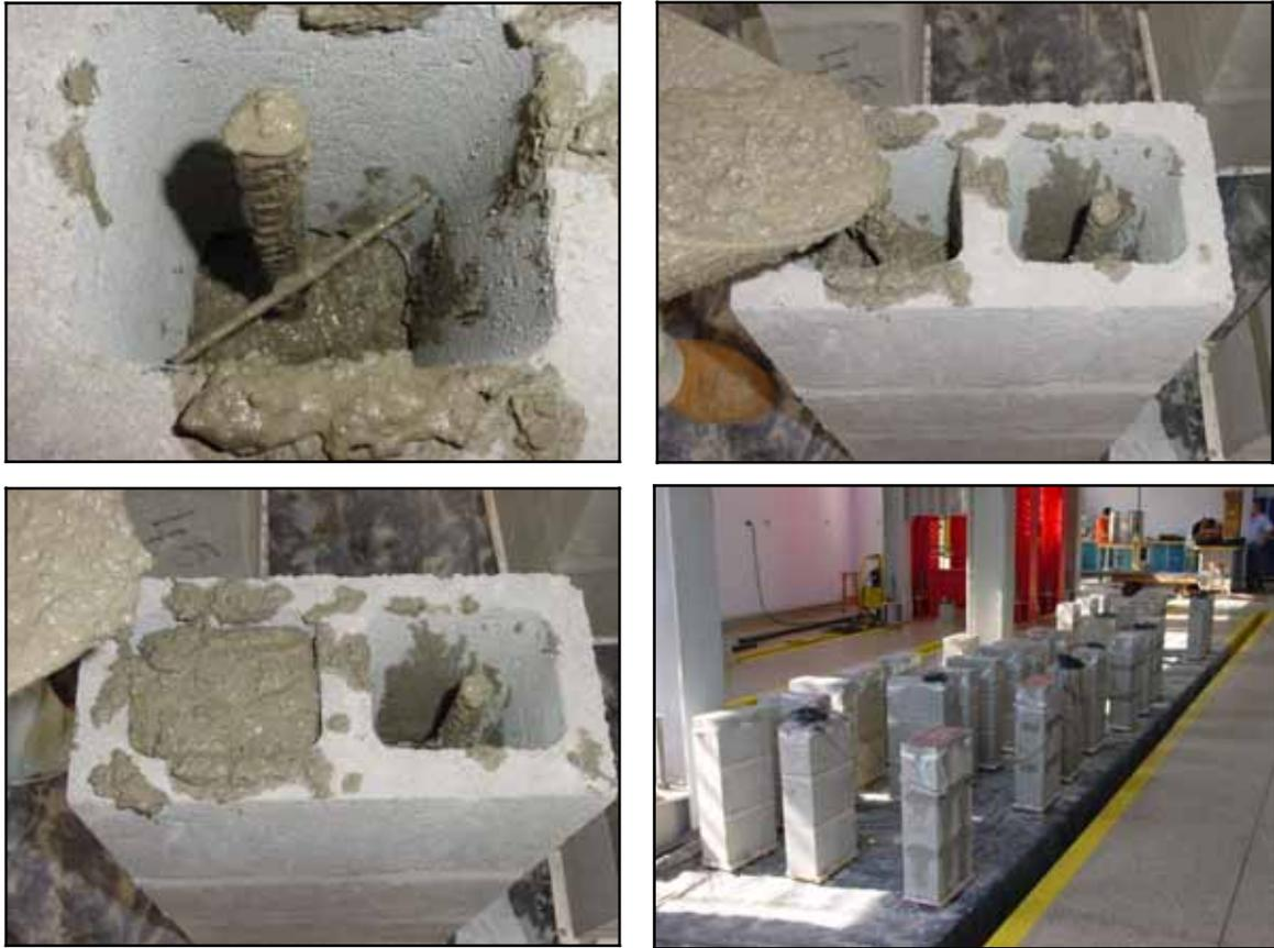
Figura 43 – Armação e grauteamento dos prismas.
