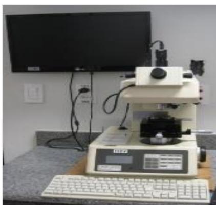
3. Os blocos foram submetidos à análise de dureza inicial, utilizando Microdurômetro. Foram inclusos no estudo blocos com valores de dureza 320-380 Knoop.
