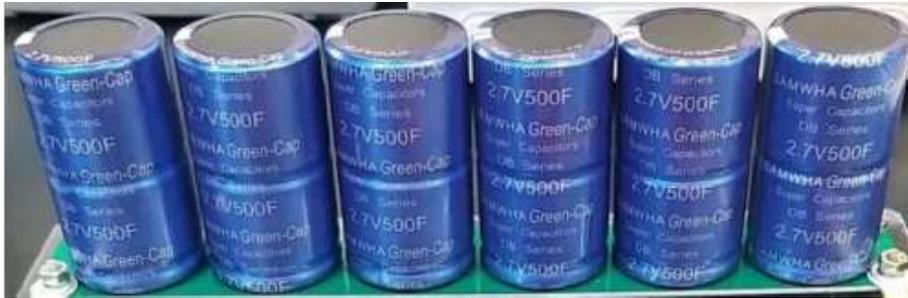
**Figura 25 – Banco de supercapacitores.**
