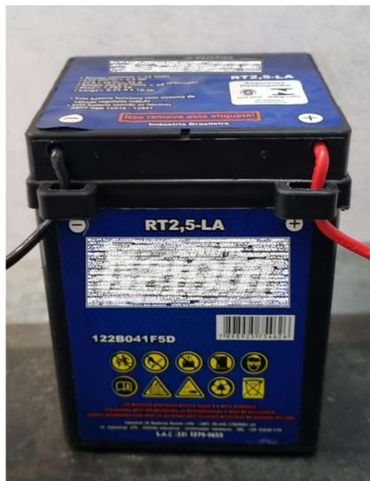
Figura 24 – Bateria chumbo ácido.
