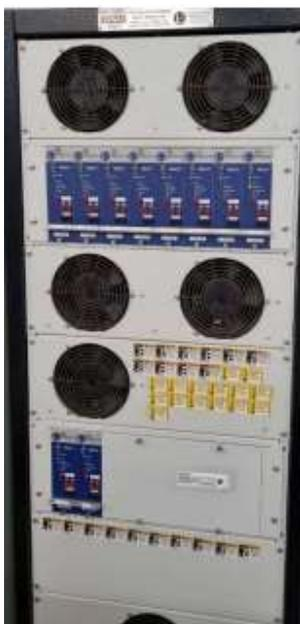
**Figura 26 – Equipamento de teste de vida ciclada.**
