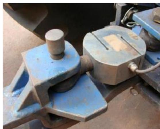
Figura 12. Célula de carga.
