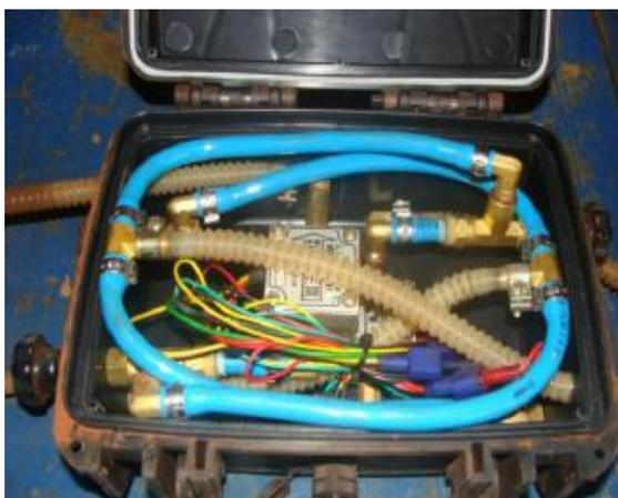
Figura 13. Medidor de consumo de combustível.
