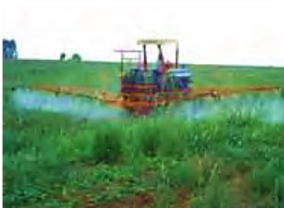
Figura 17. Pulverizador de barras. Fonte: LAMMA.
